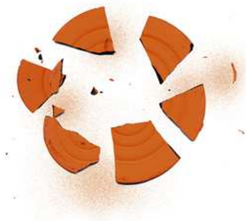
Fig. 9. Modalità di rottura e frammentazione tipiche dei piattelli – esempio
