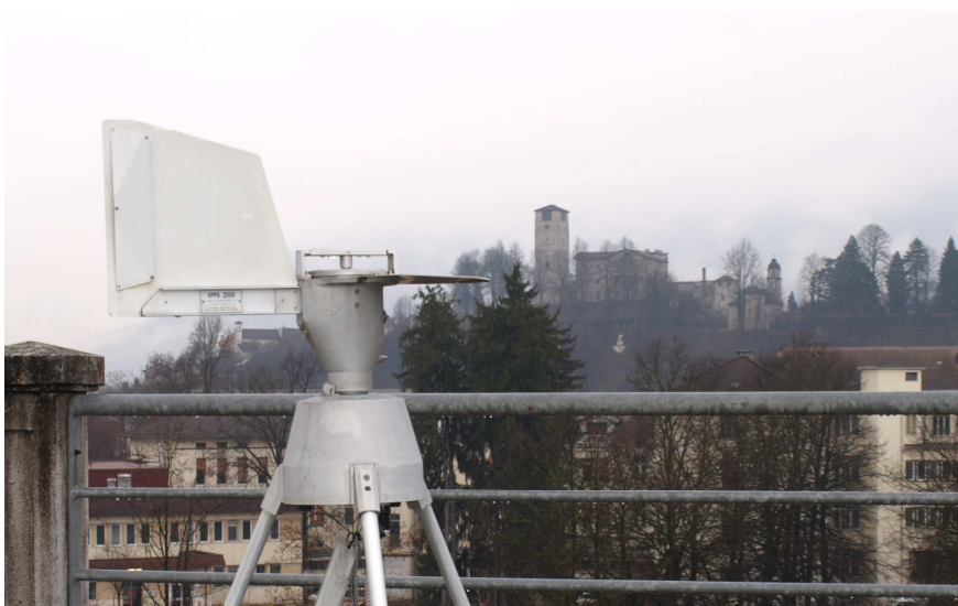
Fig. 2 Campionatore captaspore a Feltre
