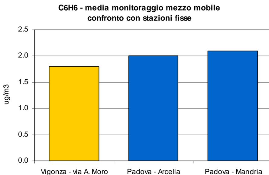
Figura 2.4 Benzene ( $\text{C}_6\text{H}_6$ ): concentrazione media rilevata durante il monitoraggio in via A. Moro nel Comune di Vigonza.
