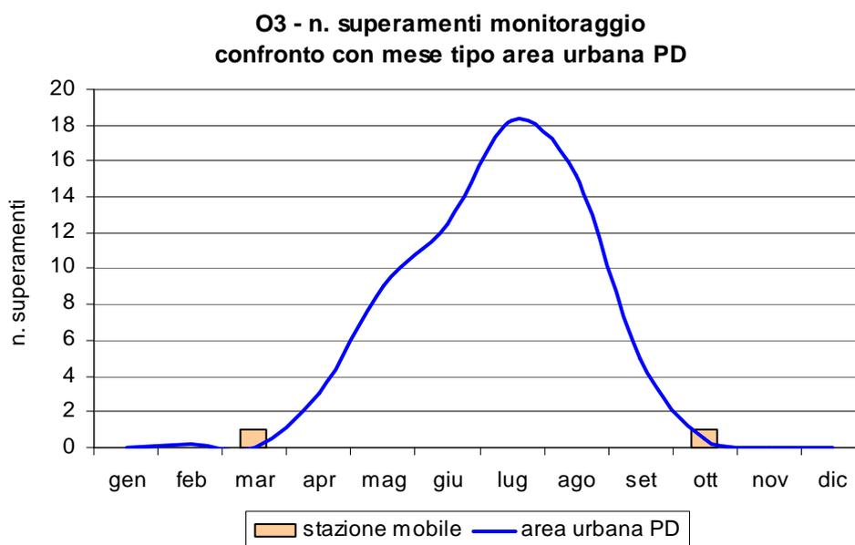
*Figura 3.1 Ozono (O<sub>3</sub>): confronto del numero di superamenti del valore del limite di protezione della salute (120 µg/m<sup>3</sup>) rilevati durante il monitoraggio in via A. Moro nel Comune di Vigonza, con l'andamento caratteristico del 'mese tipo' ricavato dai dati della serie storica della stazione fissa di Mandria.*
