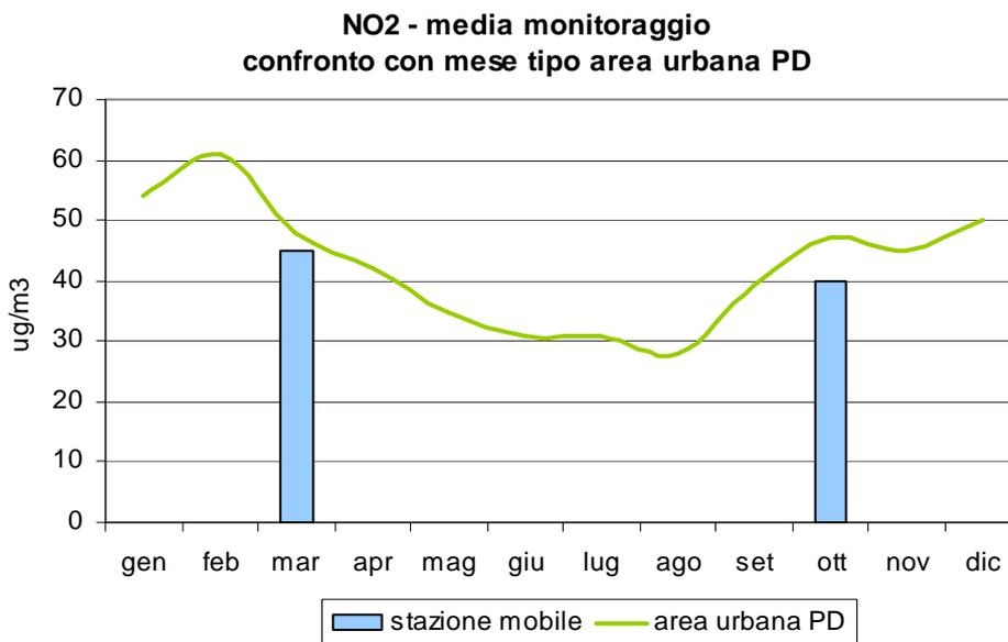
Figura 3.2 Biossido di azoto (NO<sub>2</sub>): confronto delle concentrazioni medie rilevate durante il monitoraggio in via A. Moro nel Comune di Vigonza, con l'andamento caratteristico del 'mese tipo' ricavato dalla serie storica nell'area urbana di Padova.
