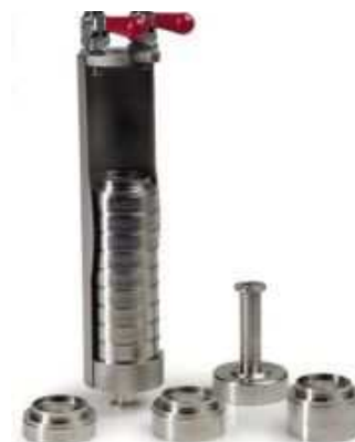
Figura 1 - Impattore DLPI (Dekati, Finlandia)
