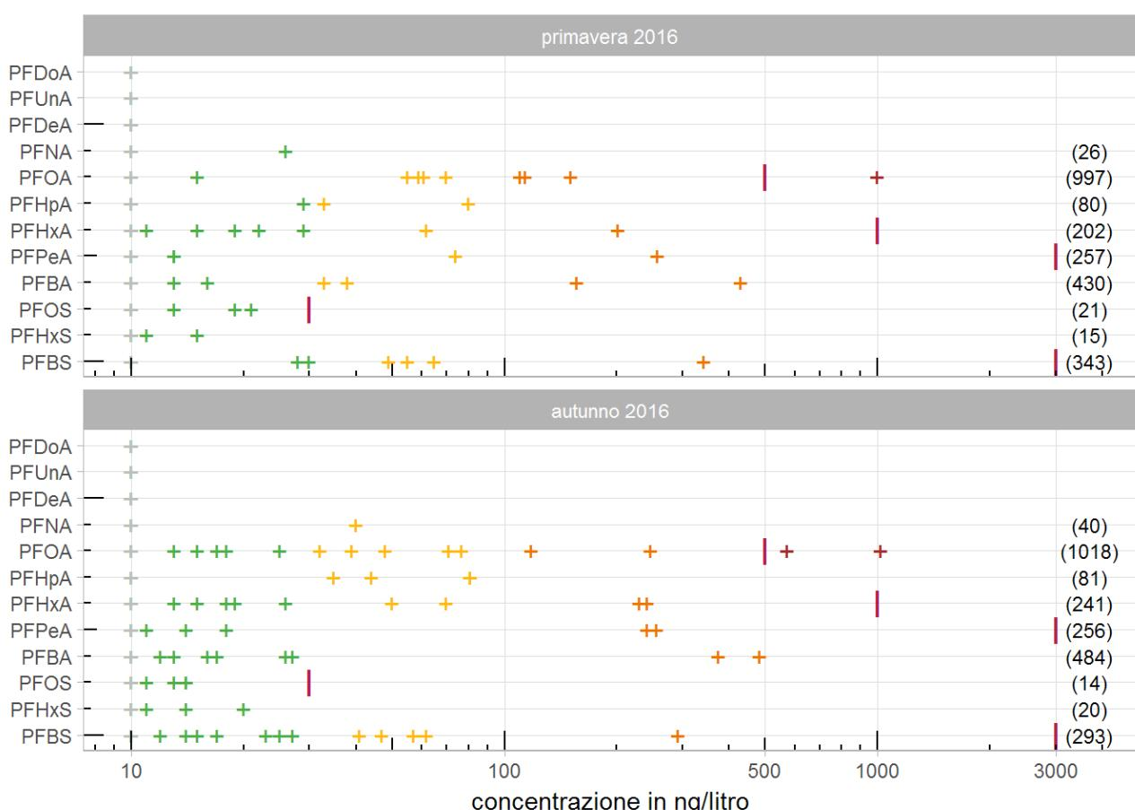
Figura 4. Concentrazione dei singoli composti nei campioni di acque sotterranee. Campioni multipli con la stessa concentrazione sono rappresentati una sola volta. Il trattino rosso | in corrispondenza di alcuni composti perfluoroalchilici indica il valore soglia fissato con il DM 6 luglio 2016, il numero tra parentesi la concentrazione massima misurata per ciascun congener.
