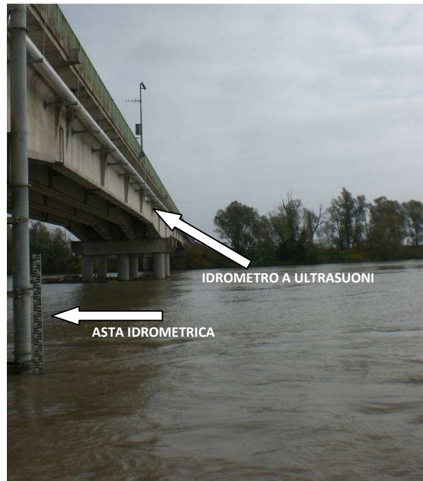
Figura 2. A sinistra: misuratore ADCP trainato da imbarcazione utilizzato per l'esecuzione delle misure di portata. A destra panoramica dell'installazione per il monitoraggio idrometrico (asta idrometrica e teleidrometro) sul Po di Gnocca.
