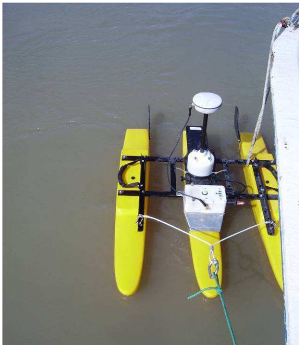
Figura 2. A sinistra: misuratore ADCP trainato da imbarcazione utilizzato per l'esecuzione delle misure di portata. A destra panoramica dell'installazione per il monitoraggio idrometrico (asta idrometrica e teleidrometro) sul Po di Gnocca.
