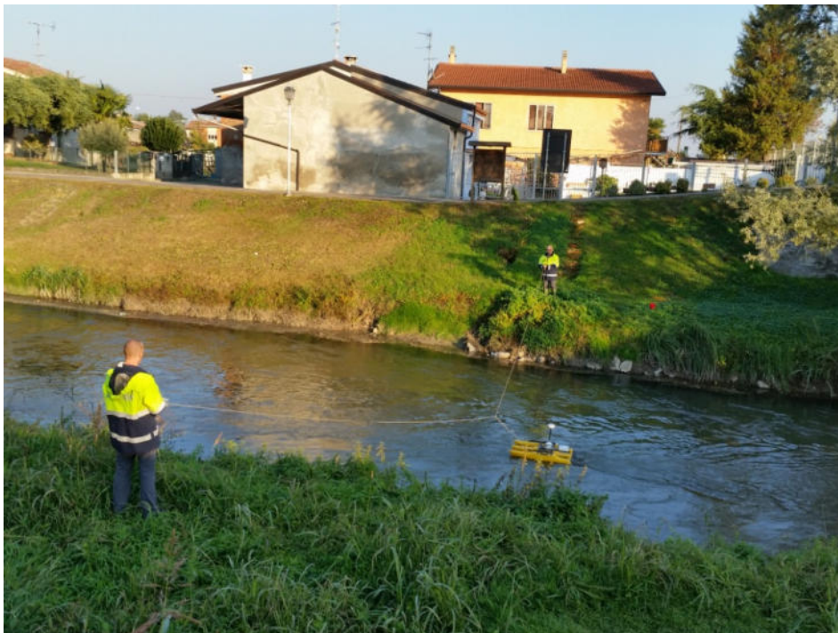
Figura 8 – Misura effettuata da sponda con profilatore acustico di velocità ad effetto Doppler (ADCP).
