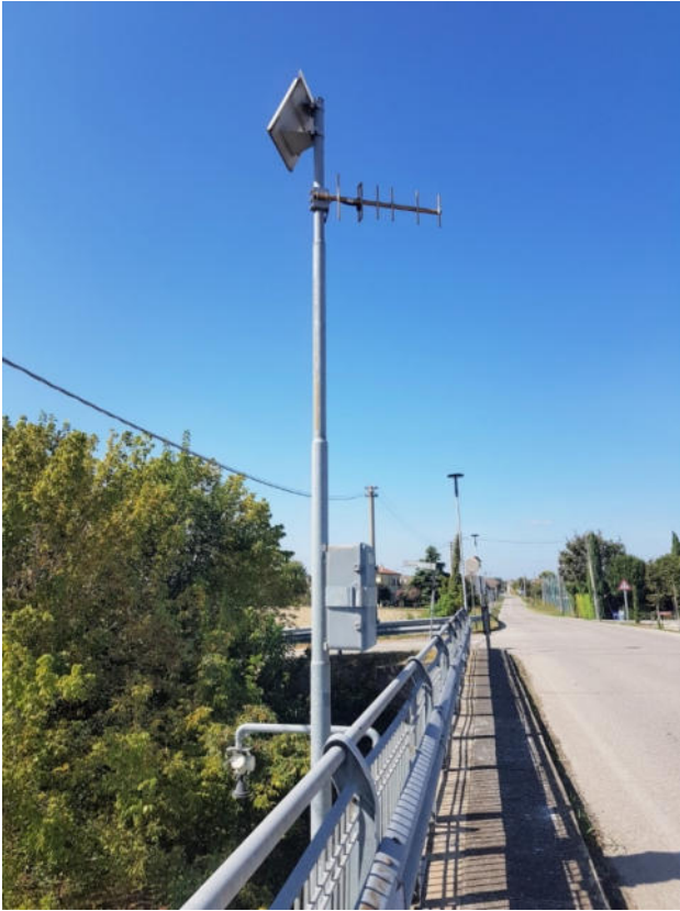
Figura 7 – Teleidrometro radar installato sul ponte.
