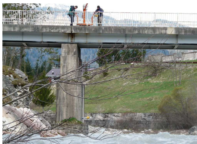
Figura 9 – Torrente Boite a Cancia: misure di portata da ponte utilizzando un correntometro montato su argano (data: 23/04/2009: portata Q = 22.024 \text{ m}^3/\text{s} )
