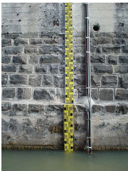
Figura 4 – Torrente Boite, stazione idrometrica di Cancia: sezione, vista da monte, e asta idrometrica centimetrata fissata sul muro di sponda sinistra
