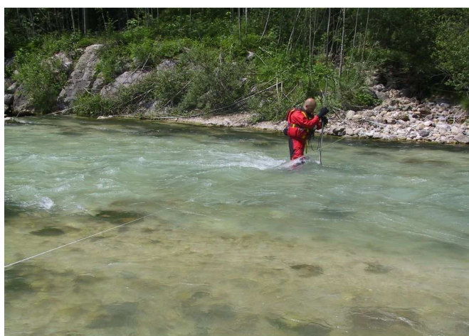
Figura 8 – Torrente Boite a Cancia: misure di portata a guado utilizzando un mulinello correntometrico (data: 28/06/2005: portata Q = 5.730 \text{ m}^3/\text{s} )
