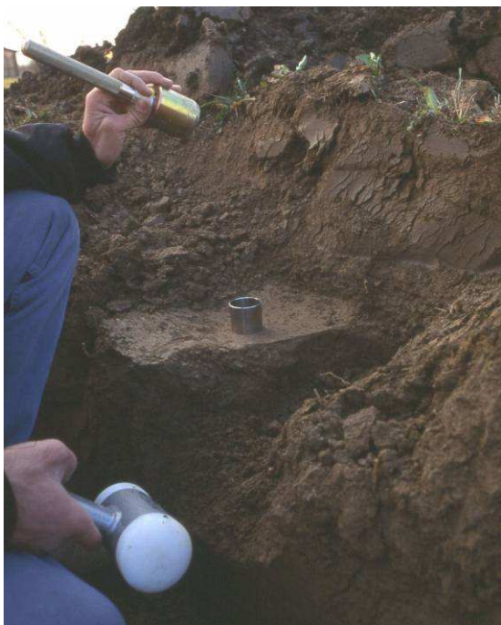
Figura 6: Prelievo di campioni indisturbati con il metodo del cilindretto; possono essere utilizzati per la misura della densità apparente o della conducibilità idrica.
