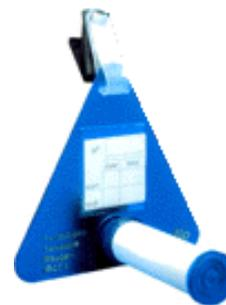
Il campionamento passivo è una tecnica di monitoraggio così definita in quanto la cattura dell'inquinante avviene per diffusione molecolare della sostanza attraverso il campionatore. Il tipo di campionatore adottato è denominato Radiello® ed è un sistema dotato di simmetria radiale al cui interno viene inserita una cartuccia adsorbente specifica per l'inquinante da ricercare.
