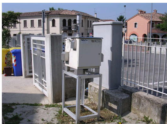
Foto 2 Campionatore rilocabile utilizzato per le campagne di Farra di Soligo e Sernaglia della Battaglia.
