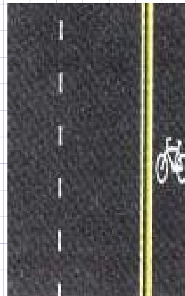
Segnaletica orizzontale della pista ciclabile
