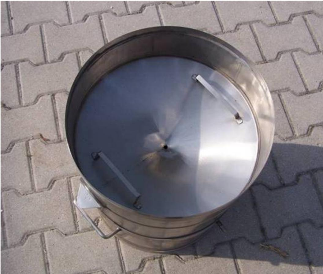
**Fig.5** – Pluviometro totalizzatore C. 10 con coperchio: vista dall'alto
