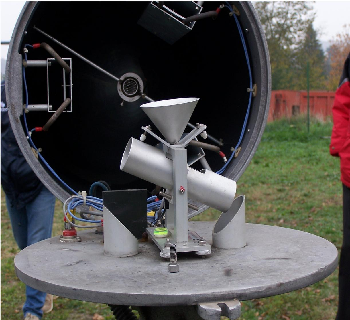
**Fig.26** – Pluviometro MTX con bocca da 1000 cm<sup>2</sup>, particolare del sistema di misura a bilance basculanti.
