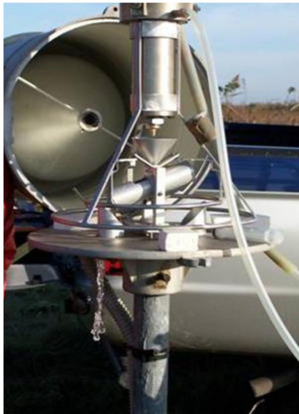
**Fig.30** – Pluviometro MTX particolare del sistema di misura a bilance basculanti durante un intervento di taratura in campo: a destra fase di carico dell'acqua a sinistra fase di scarico.
