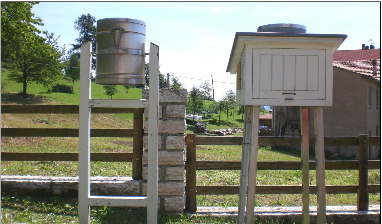
**Fig.17**- Stazione storica di Tonezza del Cimone (VI) dotata di pluviometro e pluviografo
