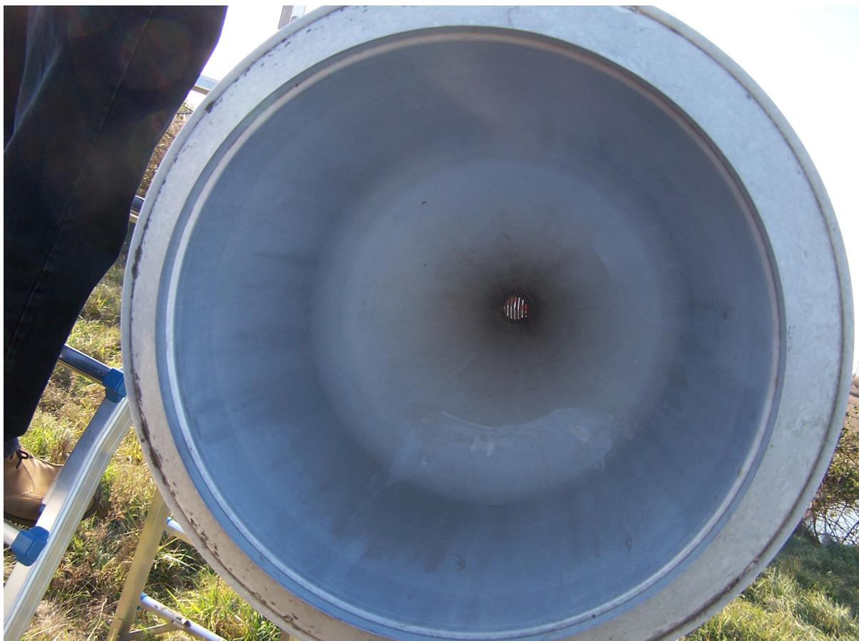
**Fig.31** – Pluviometro MTX particolare dell'imbuto di raccolta in alluminio anodizzato con bocca tarata circolare di 1000 cm<sup>2</sup>, alla base è visibile il filtro per impedire la caduta di corpi solidi nel sistema di misura.
