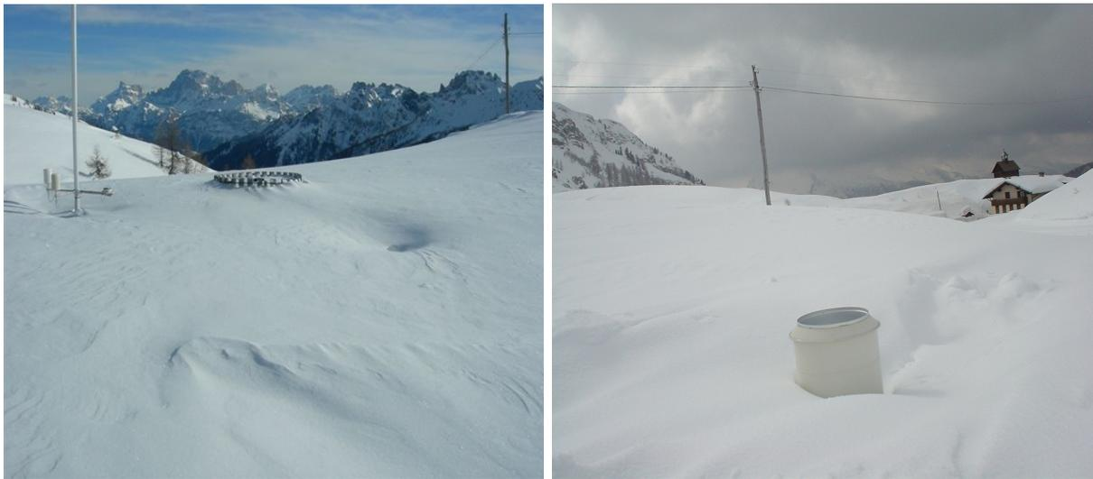
**Fig.38** – Stazione meteorologica di Passo Valles (BL) pluviometri sommersi dalla neve nei primi mesi del 2009
