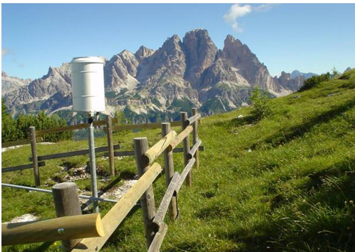
**Fig.32** – Pluviometro MTX con bocca da 1000 cm<sup>2</sup> posizionata a 2 m dal suolo - vista d'insieme
