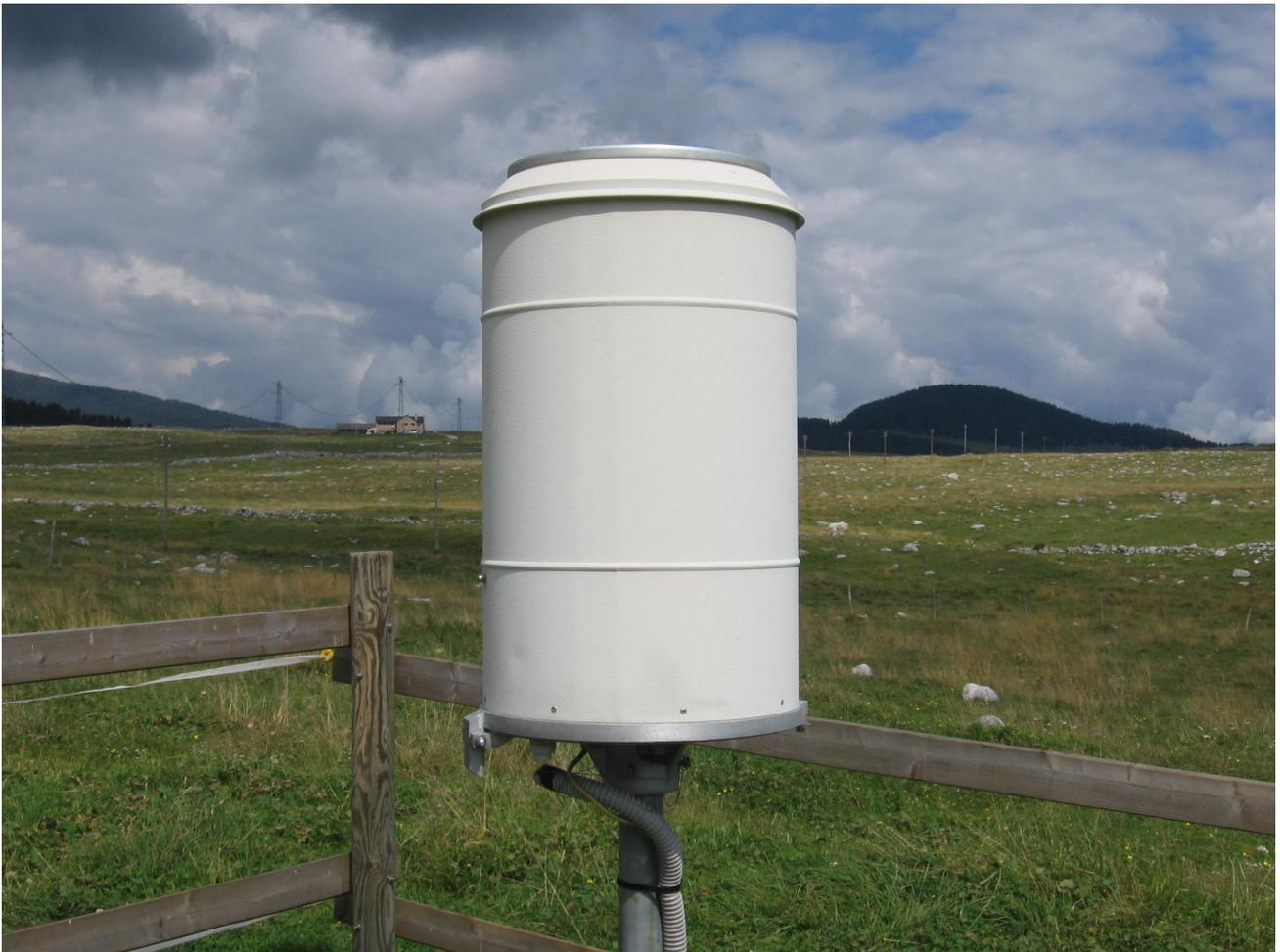
**Fig.33** – Pluviometro MTX con bocca da 1000 cm<sup>2</sup> posizionata a 2 m dal suolo – particolare del corpo dello strumento, si osservi il piccolo deflettore per il vento collocato in prossimità della bocca di captazione
