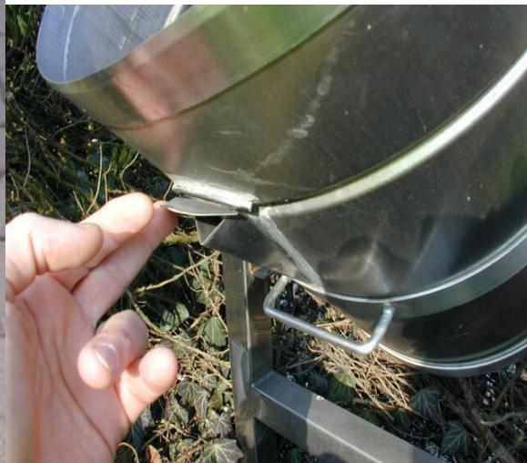
**Fig.6** – Pluviometro totalizzatore C. 10: vista di fronte e particolare del beccuccio apribile per lo svuotamento dell'acqua nel cilindro graduato
