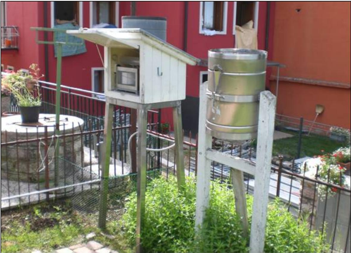
**Fig.21**- Stazione storica di Foza (VI) dotata di pluviometro e pluviografo
