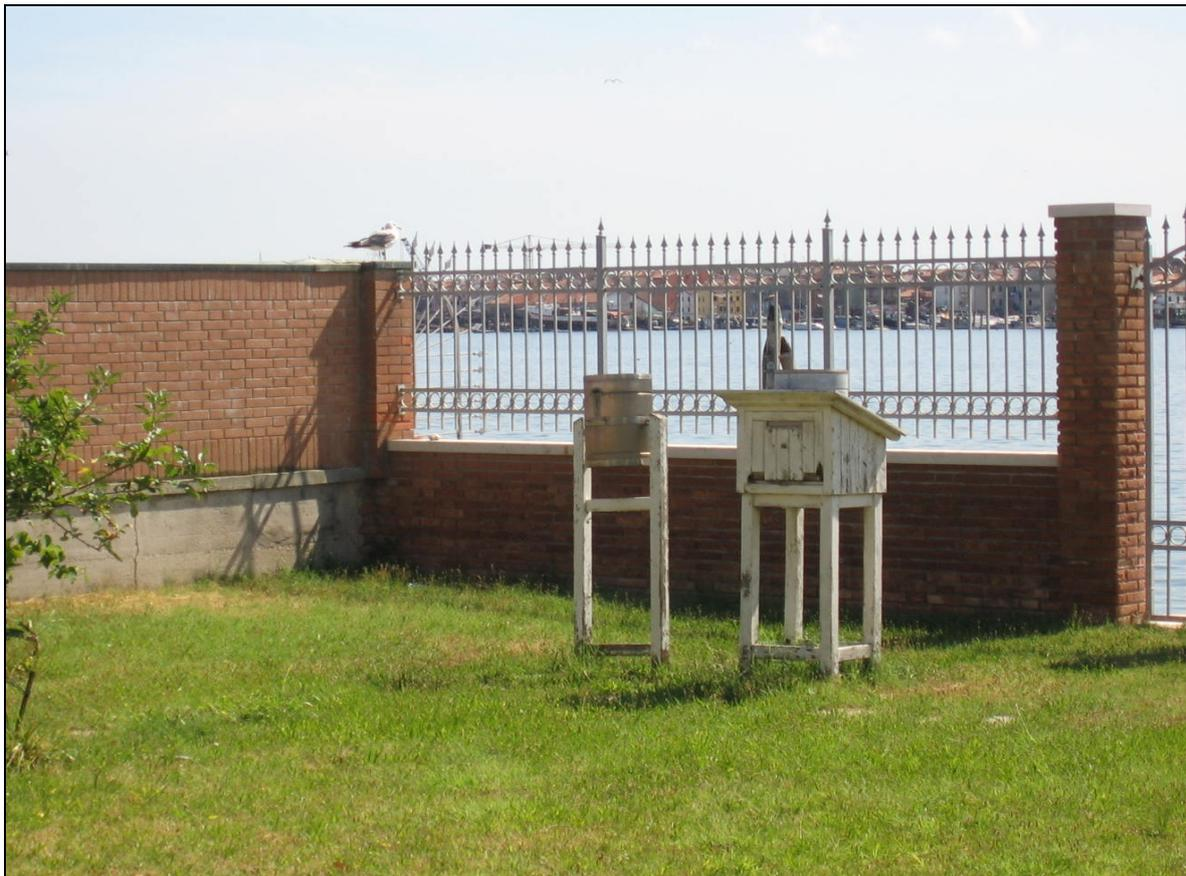
**Fig.19** - Stazione storica di Chioggia (VE) dotata di pluviometro e pluviografo
