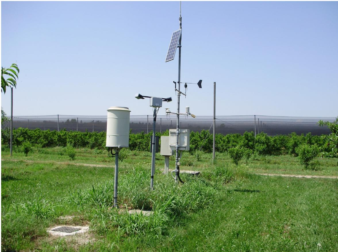
**Fig.42** – Stazione agrometeorologica secondaria di Villafranca Veronese (VR) con visibilimetro
