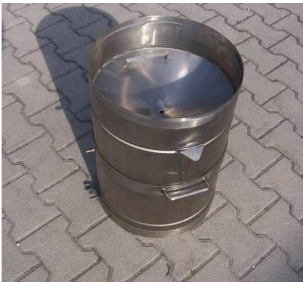
**Fig.3** – Pluviometro totalizzatore C. 10 con superficie captante da 1000 cm<sup>2</sup> diametro 35,7 cm con coperchio conico inserito a circa 10 cm dal bordo superiore
