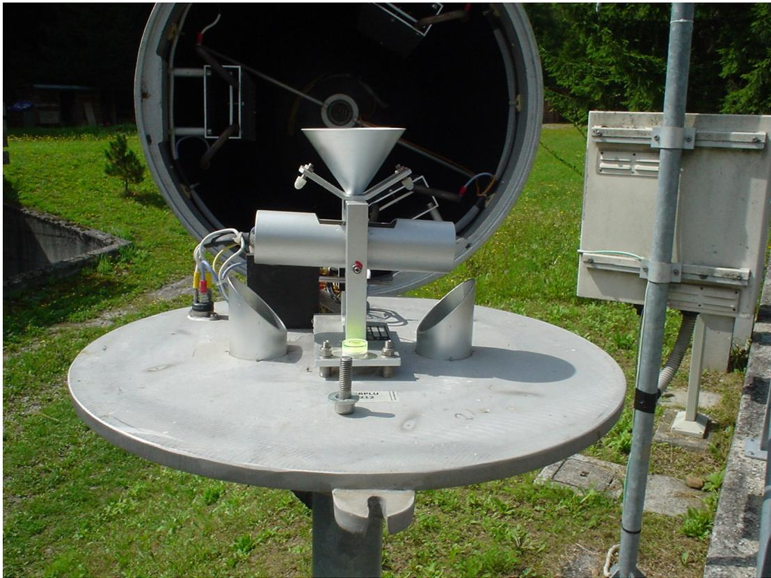
**Fig.27** – Pluviometro MTX con bocca da 1000 cm<sup>2</sup>, il sistema di misura a bilance basculanti è stato fotografato quasi a metà della fase di rovesciamento
