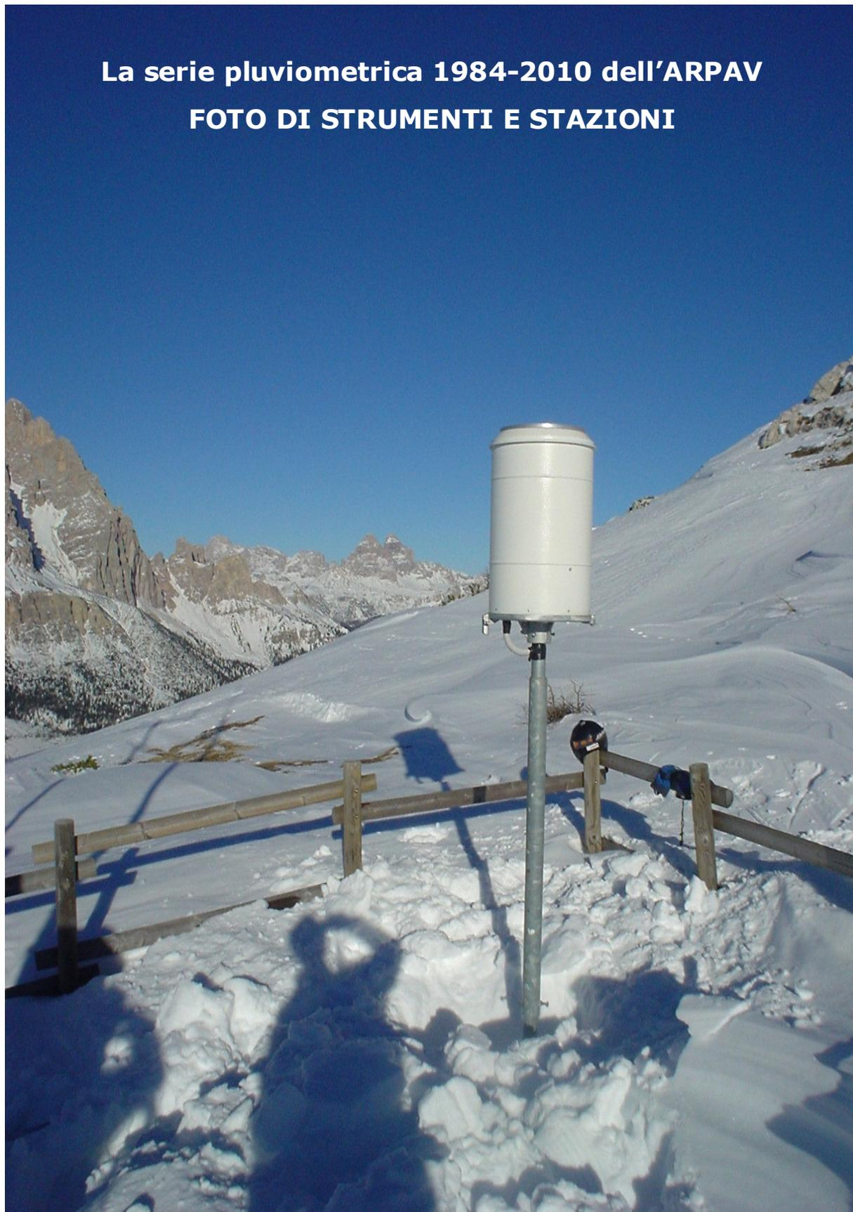
Pluviometro MTX con bocca da 1000 cm<sup>2</sup> della stazione ARPAV del Monte Faloria.
