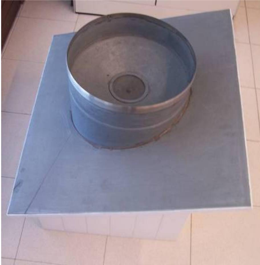
**Fig.15** - Imbuto di cattura per pluviografo registratore tipo M. 20 collocato sul tetto della capannina lignea. Superficie captante  $1000 \text{ cm}^2$  diametro 35,7 cm
