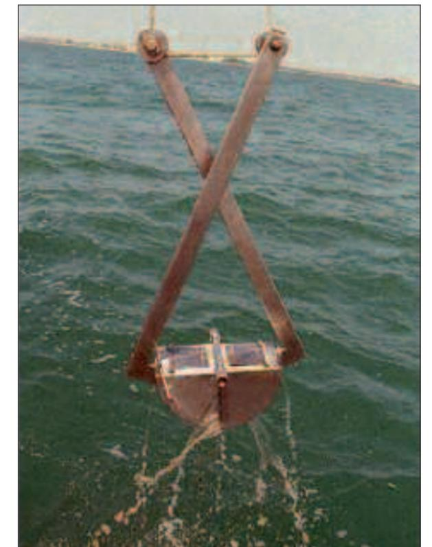
Fig. 2 - Benna per il campionamento del bentos e dei sedimenti.
