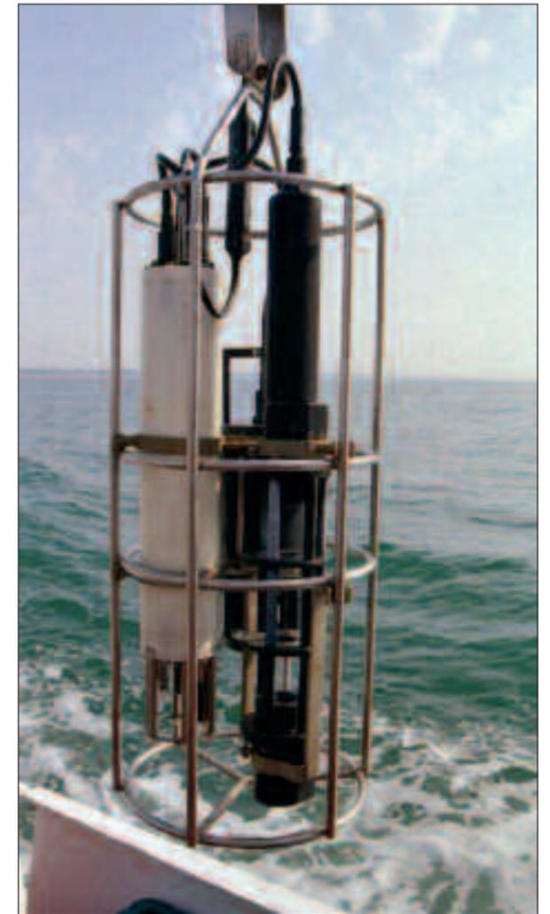
Fig. 4 - Sonda multiparametrica CTD Idronaut.
