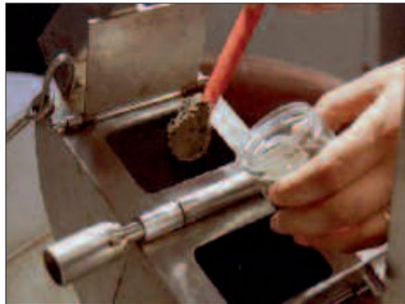
Fig. 3 - Operazione di prelievo dei campioni di sedimento da benna.
