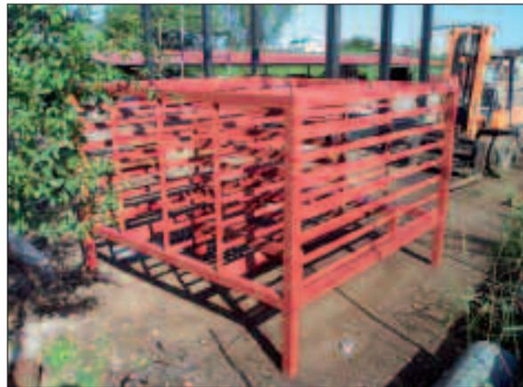
Fig. 12 - Struttura a galleggiamento controllato.
