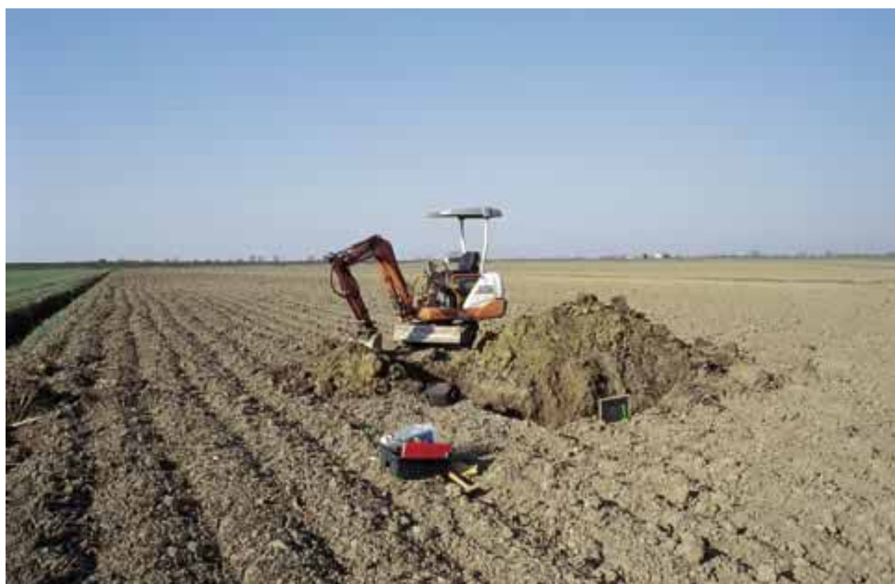
Fig. 1.7: Scavo di un profilo di suolo per mezzo di un miniescavatore
