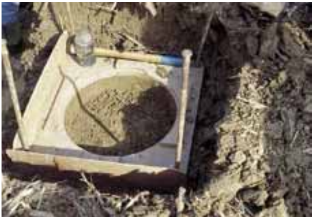
Fig. 2.6: Misurazione della densità apparente con il metodo dello scavo.
