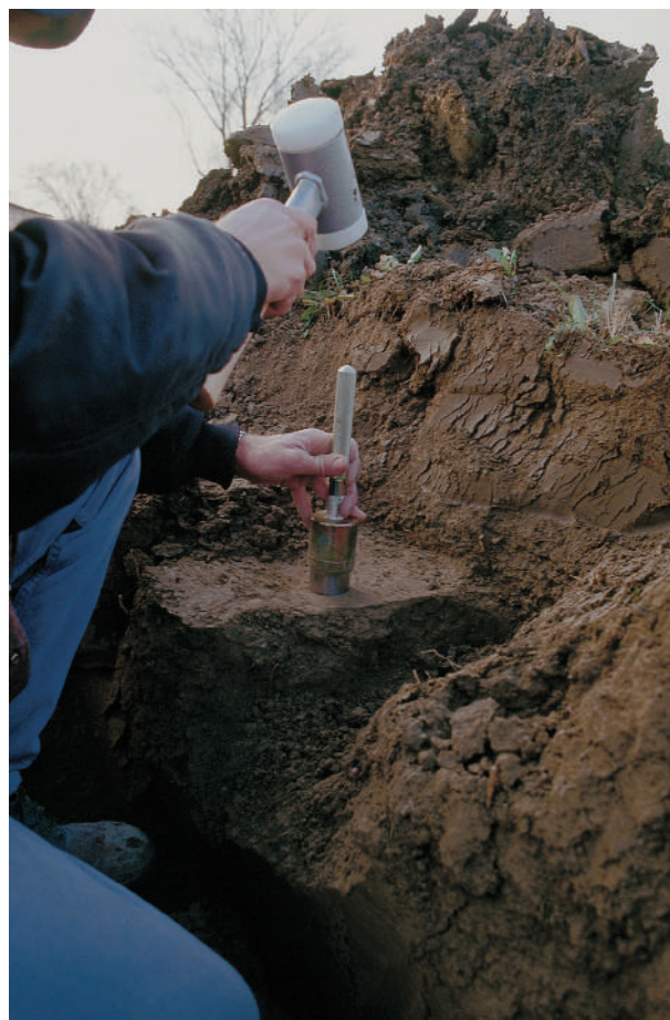
Fig. 7.3: Prelievo di campioni indisturbati con cilindri di volume noto.
