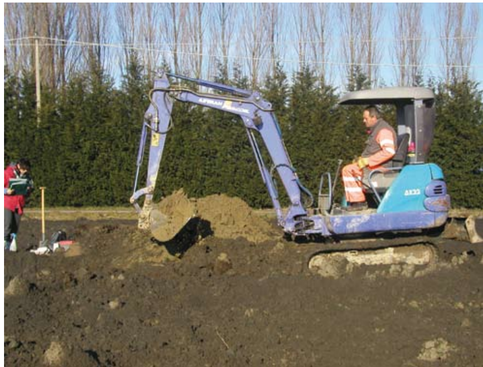
Fig. 2.2: Scavo di un profilo di suolo con miniescavatore.
