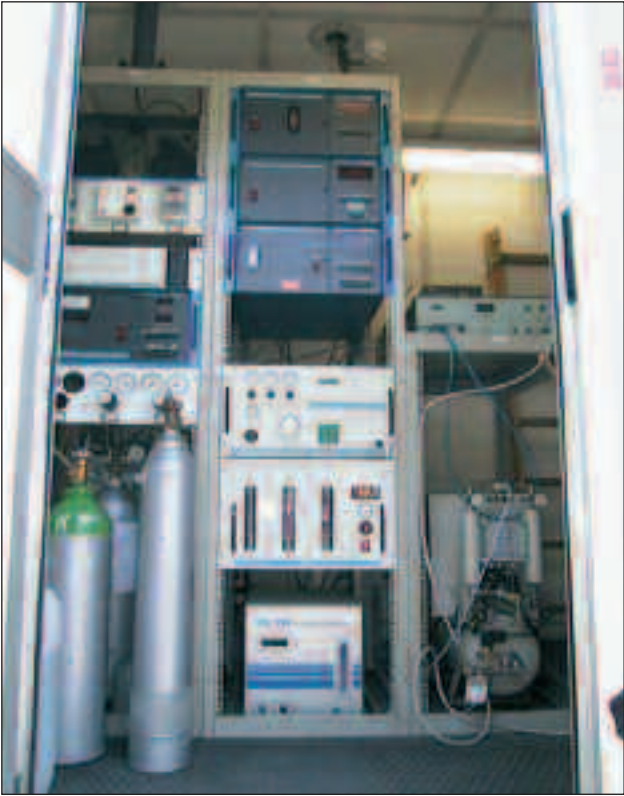
Fig. 2.24 - Interno di una stazione fissa di misura; in primo piano si nota la strumentazione di misura degli inquinanti.
