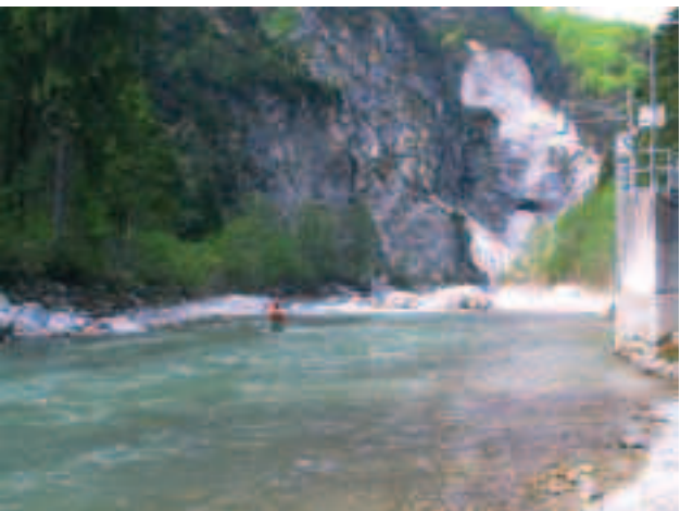
Fig. 3.3 - Misura di portata sul Fiume Piave a Ponte della Lasta.
