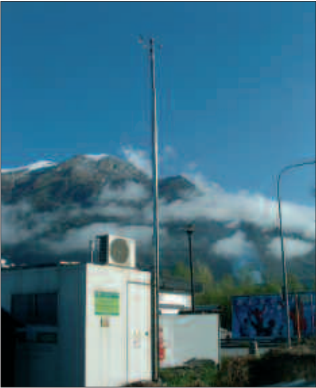
Fig. 2.22 - Stazione fissa di misura in cui sono ben visibili il condizionatore ed il palo meteo.
