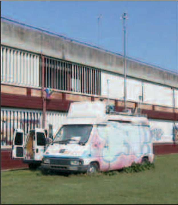
Fig. 2.23 - Stazione rilocabile di misura operativa durante una campagna di monitoraggio della qualità dell'aria.
