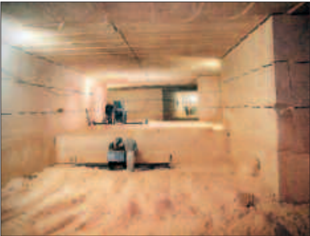
Fig. 4.27 - Esempio di coltivazione di cava in sotterraneo di pietra di Vicenza.
