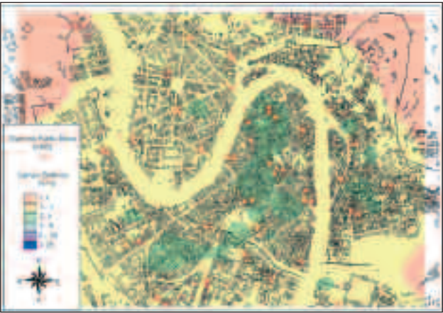
Fig. 2.64 - Simulazione del livello di campo elettrico prodotto da impianti per telefonia mobile nel centro storico del comune di Verona.
