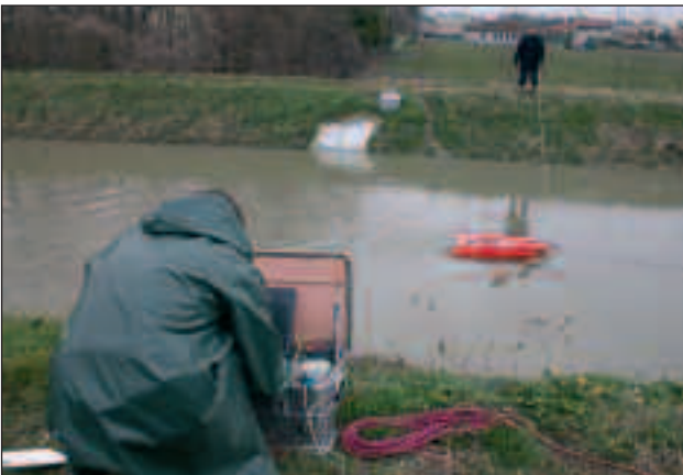
Fig. 6.7 - Rilevamento della portata con ADCP.
