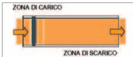
Fig. 3.24 - Schema di impianto di compostaggio a corsie a flusso continuo (flusso a pistone orizzontale): la macchina rivoltatrice ritorna a vuoto all'interno del capannone, passando sopra il cumulo. In evidenza i carichi giornalieri.
