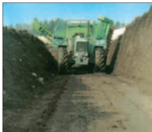
Fig. 2.35 - Rivoltatore a rotore a taglio laterale in lavoro a sinistra; in evidenza a destra il fronte di asportazione del prodotto [foto: WILLIBALD].
