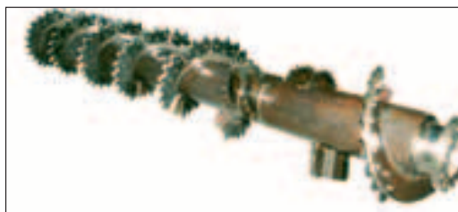
Fig. 2.12 - Particolare di un rotore cocleare [foto: PAGLIARI].
