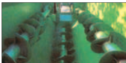
Fig. 2.9 - Apparato di triturazione a tre coclee, analogo a quello dei carri unifeed [foto: FARESIN].
