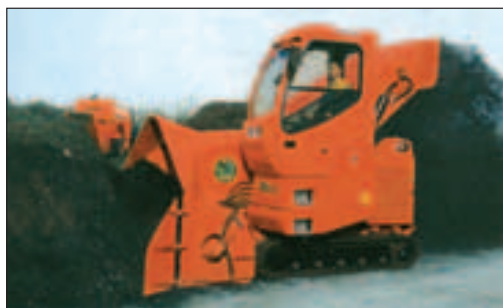
Fig. 2.31 - Rivoltatore semovente a nastro elevatore inclinato con convogliatore anteriore cocleare [foto: SEKO].
