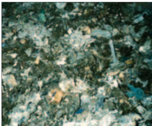
Fig. 3.2 - La frazione organica di RSU proveniente da operazioni di separazione da raccolta indifferenziata non viene trattata per la produzione di compost di qualità, ma stabilizzata prima della collocazione in discarica.
