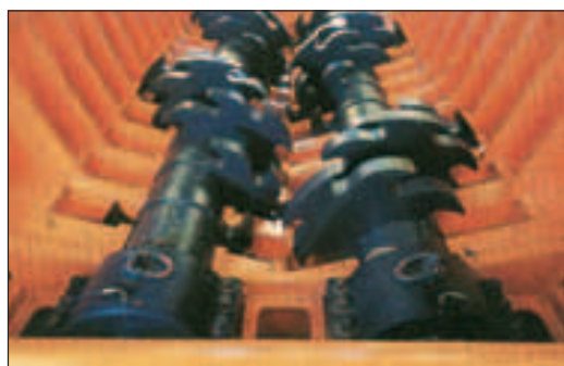
Fig. 2.2 - Apparatı di triturazione a uno e due rotori utilizzati per la frantumazione di RSU e legname da demolizioni [foto: NIRO INDUSTRIES].
