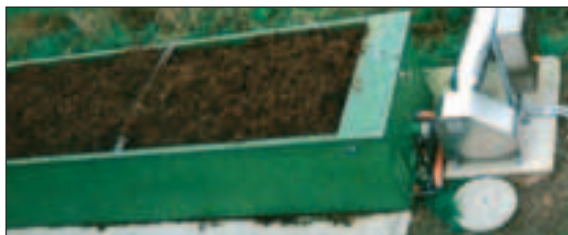
Fig. 4.18 - Biofiltro prefabbricato modulare con copertura [foto: THOLANDER].
