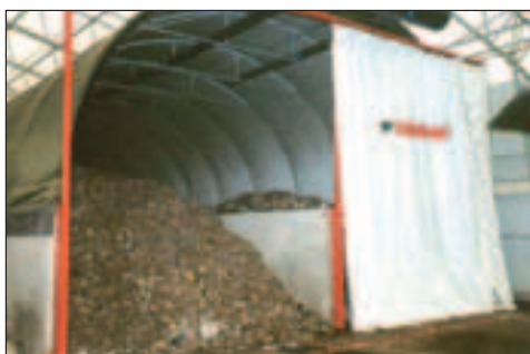
Fig. 3.80 - Biocelle statiche THÖNI da interno e da esterno con in evidenza i due sistemi di chiusura: a tenda e a tapparella.
