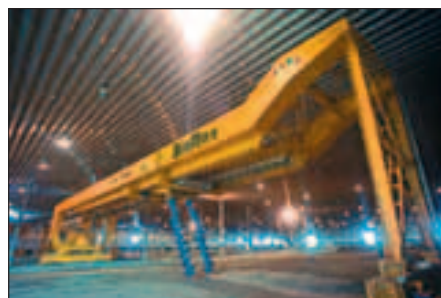
Fig. 3.40 - Impianto a bacino di grandi dimensioni con in evidenza il carroponte [foto: SCT].
