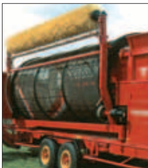
Fig. 2.50 - Particolare del rullo di pulizia di un vaglio selezionatore [foto:TIM].
