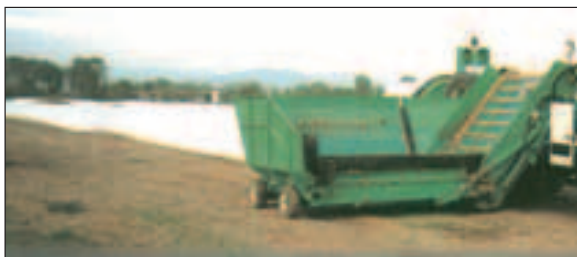
Fig. 3.14 - Primo piano della tramoggia di carico della macchina insaccatrice [foto: CTI].
