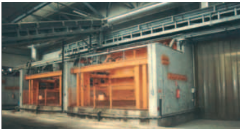
Fig. 3.85 - Tunnel SIT con particolare del nastro di carico superiore
