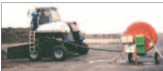
Fig. 2.26 - Macchina semovente collegata a sistema di irrigazione dei cumuli a rotolone [foto: KOMPTECK].
