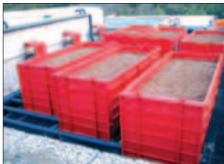
Fig. 4.19 - Biofiltri a container del tipo aperto e chiuso [foto: THÖNI].
