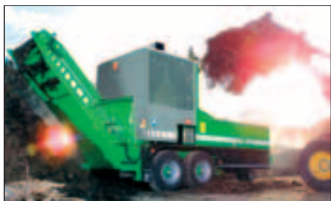
Fig. 2.5 - Carico con pala gommata e scarico su nastro: la presenza del nastro consente una migliore formazione del cumulo [foto: WILIBALD].
