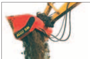
Fig. 2.40 - Rivoltamento con benna a fondo mobile [foto: ALLU].
