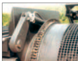
Fig. 2.49 - Particolari di un vaglio selezionatore: il rullo selezionatore in fase di sostituzione (a sinistra), il sistema di trasmissione del moto (destra) e la griglia di vagliatura grossolana asportabile (al centro) [foto: DOPPSTADT].
