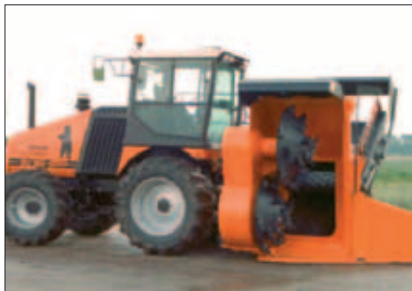
Fig. 2.37 - Rivoltatrice a due rotori ad asse di rotazione orizzontale a traslazione laterale e particolare delle lame montate sul rotore [foto: DOPPSTADT].
