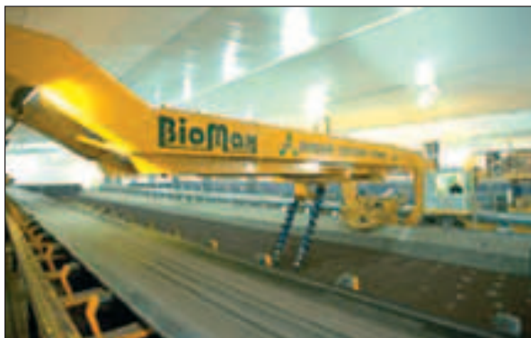
Fig. 3.48 - Impianto di rivoltamento cocleare con in evidenza le due coclee ed il nastro trasportatore di servizio all'impianto [foto: SCT].
