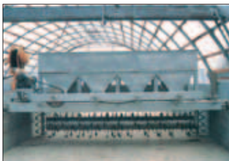
Fig. 3.30 - Macchina rivoltatrice con rotore a flagelli [foto: KISHI].
