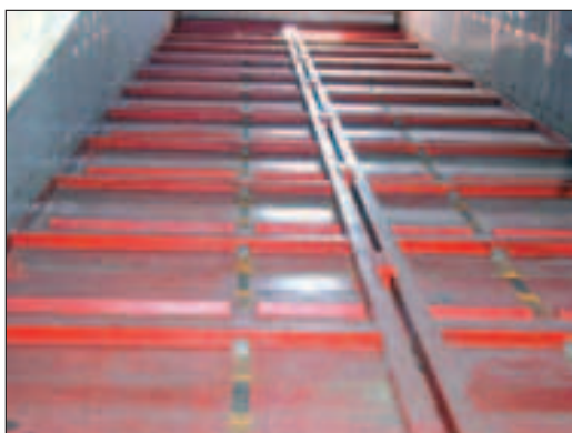
Fig. 3.57 - Particolare della pavimentazione a tappeto mobile di una biocella dinamica THÖNI.
