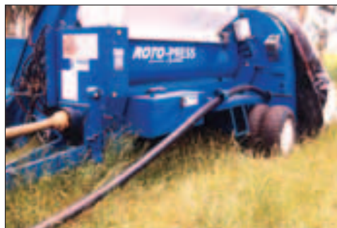
Fig. 3.16 - Primo piano della macchina insaccatrice con in evidenza una delle tubazioni forate inserite nel saccone per la distribuzione dell'aria [Foto: APIESSE].
