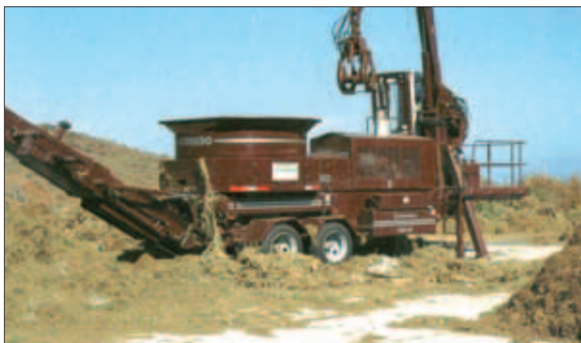
Fig. 2.19 - Macchina frantumatrice con molino a martelli a tramoggia rotante [foto: SANDBERGER].
