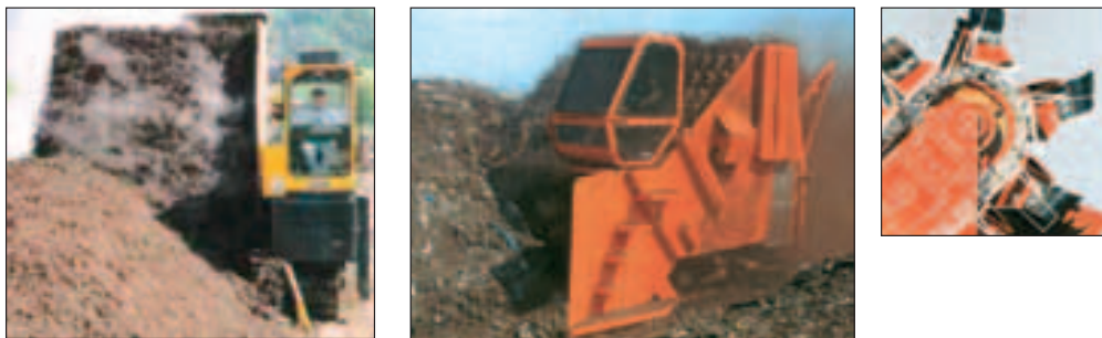
Fig. 2.29 - Rivoltatori semoventi a nastro elevatore inclinato in lavoro e particolare le lame di taglio montate sul nastro [foto: SCAT ENG. e GANDINI ].
