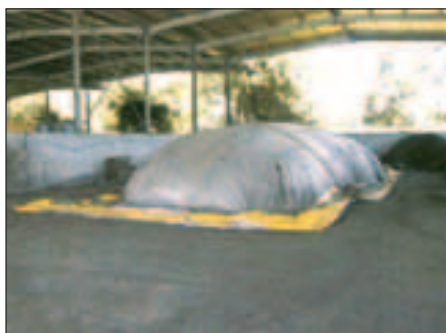
Fig. 3.12 - Cumuli a ventilazione forzata con telo di copertura e particolare del sistema di insufflazione dell'aria [fonte: BIOE].
