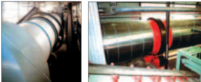
Fig. 3.50 - Particolari di impianti a cilindro rotante DANO [fonte: ICS].
