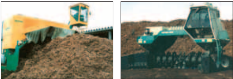
Fig. 2.23 - Rivoltatrici scavallatrici semoventi in lavoro all'aperto [fonte: BACKHUS, a sinistra e KOMPTECH a destra].
