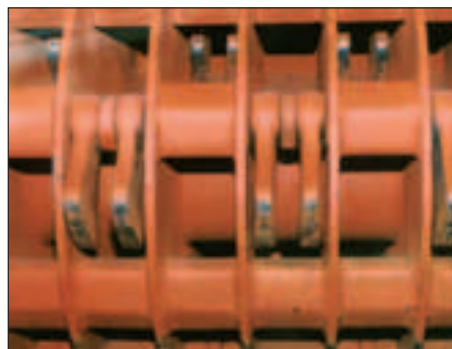
Fig. 2.15 - Apparato di frantumazione a martelli e particolare degli stessi [foto: WILLIBAND].
