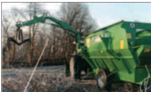
Fig. 2.8 - Carro frantumatore derivato dai carri unifeed di impiego zootecnico, dotato anche di benna di carico [foto: FARESIN].
