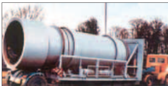
Fig. 2.21 - Miscelatore a tamburo rotante in fase di trasporto: è funzionalmente analogo ai bioreattori orizzontali rotanti [fonte: UT].
