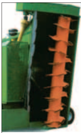
Fig. 2.36 - Particolare dell'apparato fresante di una macchina a traslazione laterale portata da trattore [fonte: WILLIBALD].
