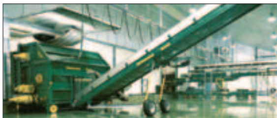
Fig. 3.64 - Sistema di scarico di una biocella a pavimentazione mobile [foto: CHRISTLAENS].
