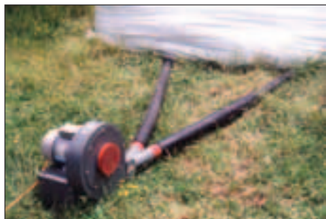
Fig. 3.15 - Particolare del sistema di insufflazione dell'aria dell'impianto [Foto: APIESSE].
