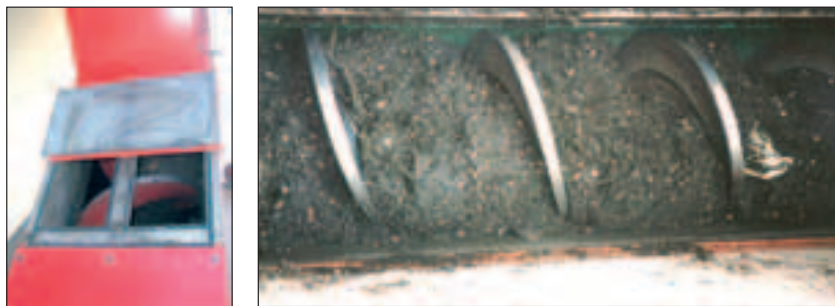
Fig. 3.61 - Particolare di una coclea utilizzata nelle biocelle dinamiche THÖNI e bocchetta di ispezione.
