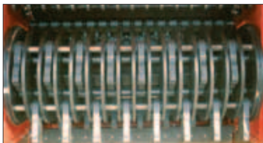
Fig. 2.14 - Apparato di frantumazione a martelli [foto:TIM].
