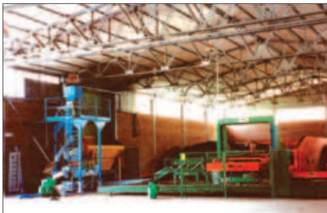
Fig. 2.53 - Impianto automatizzato di confezionamento in un centro di lavorazione di compost zootecnico.
