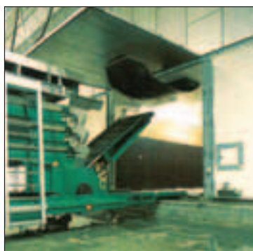
Fig. 3.62 - Particolari di un nastro telescopico di carico in una biocella [foto: CHRISTIAENS].
