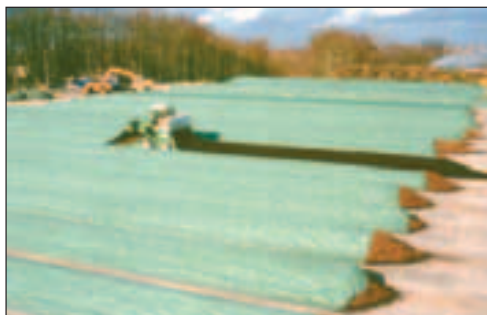
Fig. 3.20 - Cumuli dinamici all'aperto coperti con teli in Gore-Tex, con macchina rivoltatrice in lavoro [foto: SANDBERGER].
