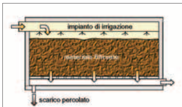
Fig. 4.5 - Schema funzionale di biofiltro down-flow con impianto di umidificazione dell'aria in entrata.
