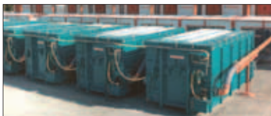
Fig. 4.19 - Biofiltri a container del tipo aperto e chiuso [foto: THÖNI].
