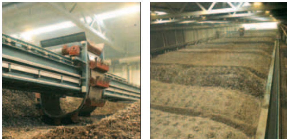
Fig. 3.45 - Impianto HORSTMANN: a sinistra l'apparato rivoltatore a rotore a tazze montato su ponteggio aereo e a destra una vista dell'impianto in cui si notano: sullo sfondo uno dei due ponteggi con il rivoltatore, i diversi cumuli che costituiscono la platea e uno dei nastri trasportatori longitudinali utilizzati per la movimentazione del prodotto.
