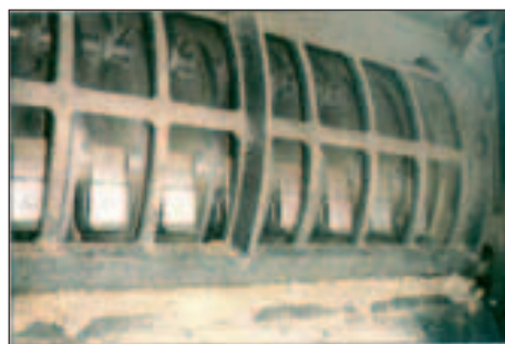
Fig. 2.16 - Particolari di griglie montate su apparati di frantumazione a martelli [Foto: TIM a sinistra e JENZ a destra].
