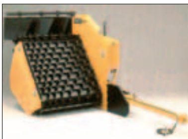
Fig. 2.30 - Rivoltatore a nastro inclinato di tipo trainato [foto: SCAT ENG. ].
