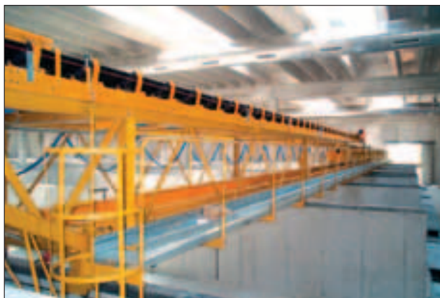
Fig. 3.38 - Impianto a corsie con in primo piano il nastro trasportatore a navetta utilizzato per il carico [foto: DE NICOLA].
