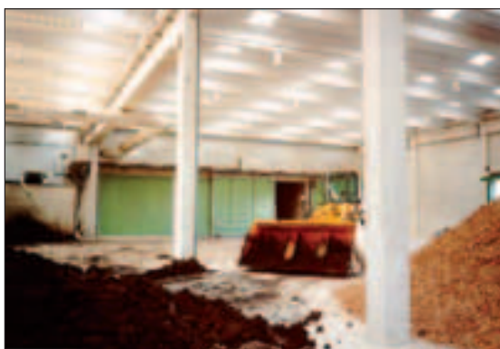
Fig. 3.60 - Il sistema di carico delle celle più usato: la pala gommata [foto: GICOM].
