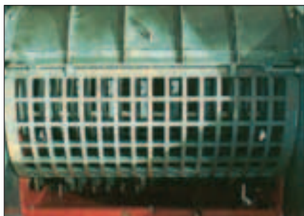
Fig. 2.16 - Particolari di griglie montate su apparati di frantumazione a martelli [Foto: TIM a sinistra e JENZ a destra].
