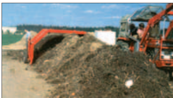
Fig. 2.28 - Macchina scavallatrice portata da trattore: sopra, in lavoro; a destra, in posizione di trasporto [foto: SANDBERGER].
