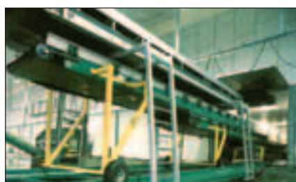
Fig. 3.62 - Particolari di un nastro telescopico di carico in una biocella [foto: CHRISTIAENS].
