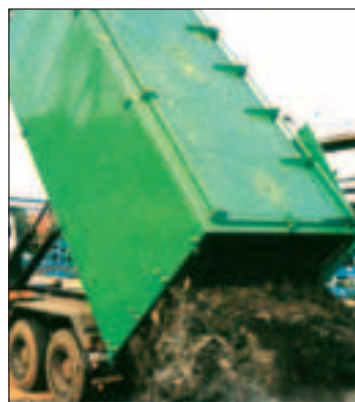
Fig. 3.83 - Operazione di ribaltamento del biocontainer a fine ciclo [foto: HORTSMANN].
