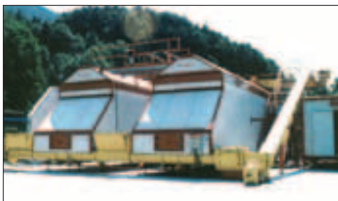
Fig. 3.75 - Batteria di biocelle dinamiche THÖNI con in evidenza la coclea inclinata di carico/ricircolo e quella frontale di scarico.
