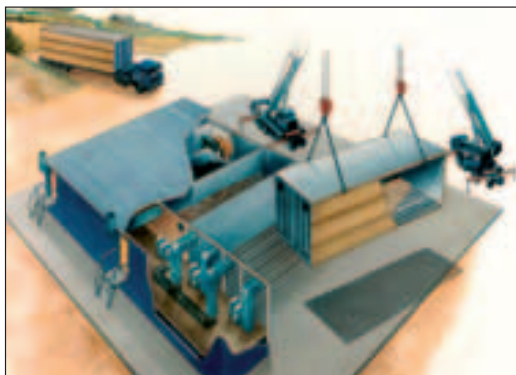
Fig. 3.72 - Schema del trasporto e montaggio di biocelle prefabbricate GICOM.
