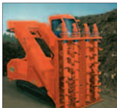
Fig. 2.34 - Operatrice semovente a doppio nastro elevatore inclinato con apparato cocleare verticale [foto: SEKO].
