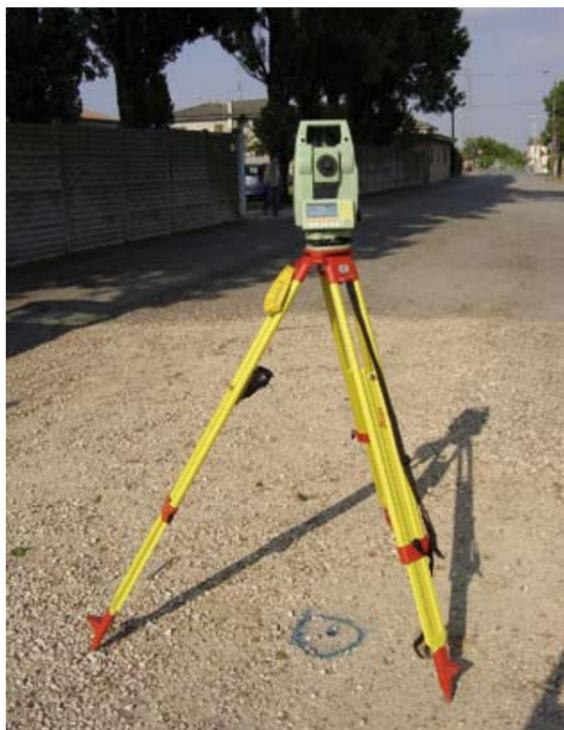
Figura 14. Teodolite. I teodoliti sono strumenti specifici per la misura diretta di angoli azimutali e zenitali.
