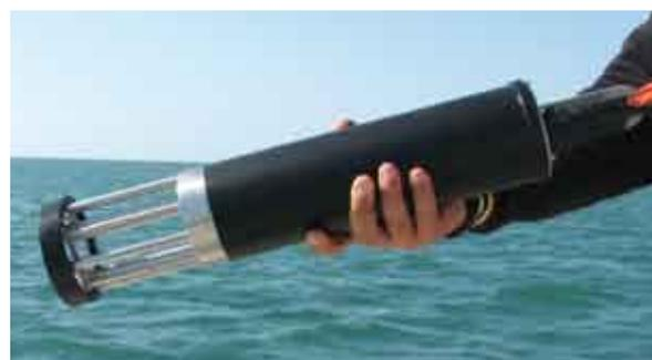
Fig. 18- La sonda di velocità Reson SVP 15 utilizzata per eseguire i profili dell'intera colonna d'acqua
