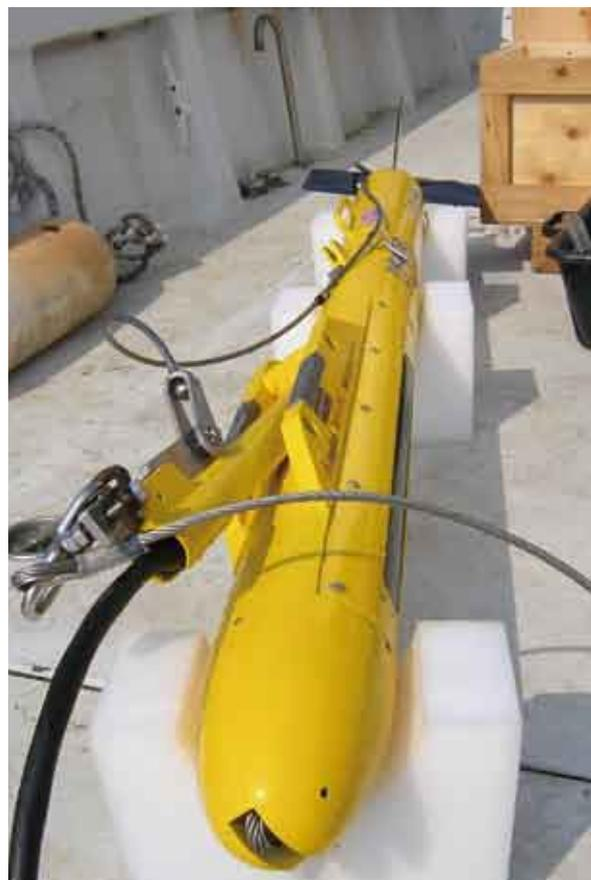
Fig. 2 - Particolari del Tow Fish Edge Tech, modello DF-1000/DCI Digital Side Scan Sonar System, utilizzato per l'acquisizione delle immagini proposte in questo studio
