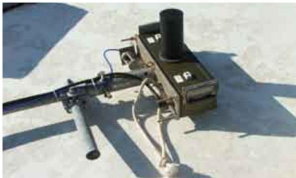
Fig. 13 - Particolare del trasduttore del sistema Reson Seabat 8125 utilizzato
