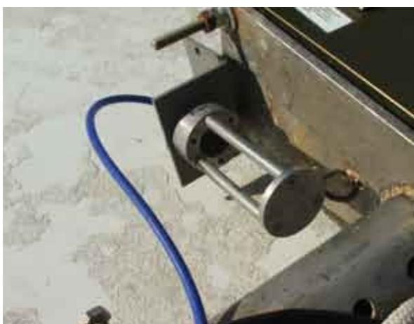
Fig. 17- La sonda di velocità Reson SVP-C/110 che è stata montata sul palo vicino al trasduttore per conoscere la velocità del suono al passaggio trasduttore-acqua
