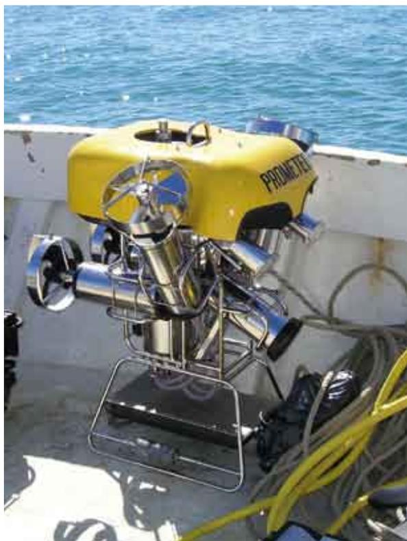
Fig. 39 - Remotely Operated Vehicle (R.O.V.) Prometeo prodotto dalla società Elettronica ENNE utilizzato per quest'indagine
