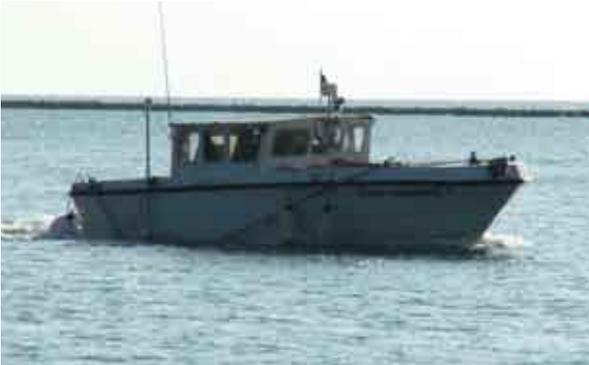
Fig. 11 - L'imbarcazione Castorino 2 in acquisizione. L'immagine mostra il palo su cui è stato installato il Multibeam Reson SeaBat 8125
