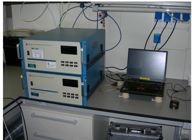
Figura 26 - Analizzatori di O<sub>3</sub> ed NO/NO<sub>2</sub>/NO<sub>x</sub> durante le prove
