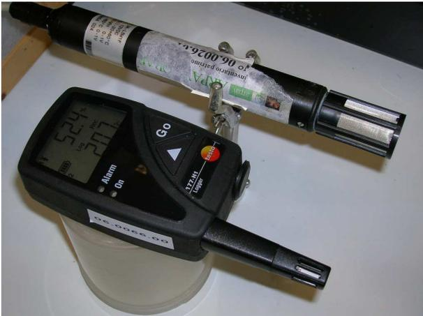
Figura 15 - Sonda combinata (certificata) per la misura di temperatura, pressione ed umidità relativa (in alto); sonda sostitutiva per la misura di temperatura ed umidità relativa (in basso)
