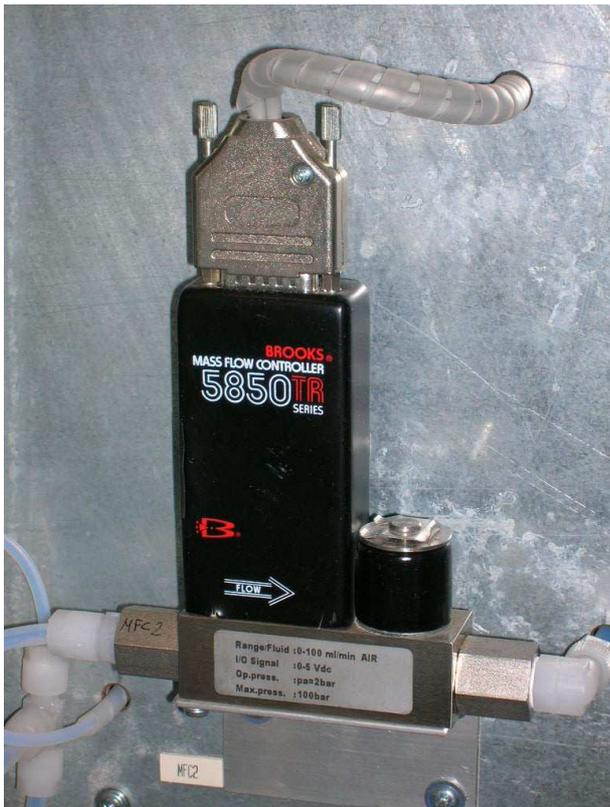
Figura 30 - Particolare del diluitore, un Mass Flow Controller
