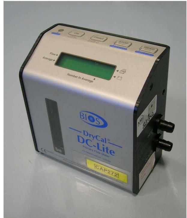
Figura 35 - Flussimetro a pistone a secco della BIOS
