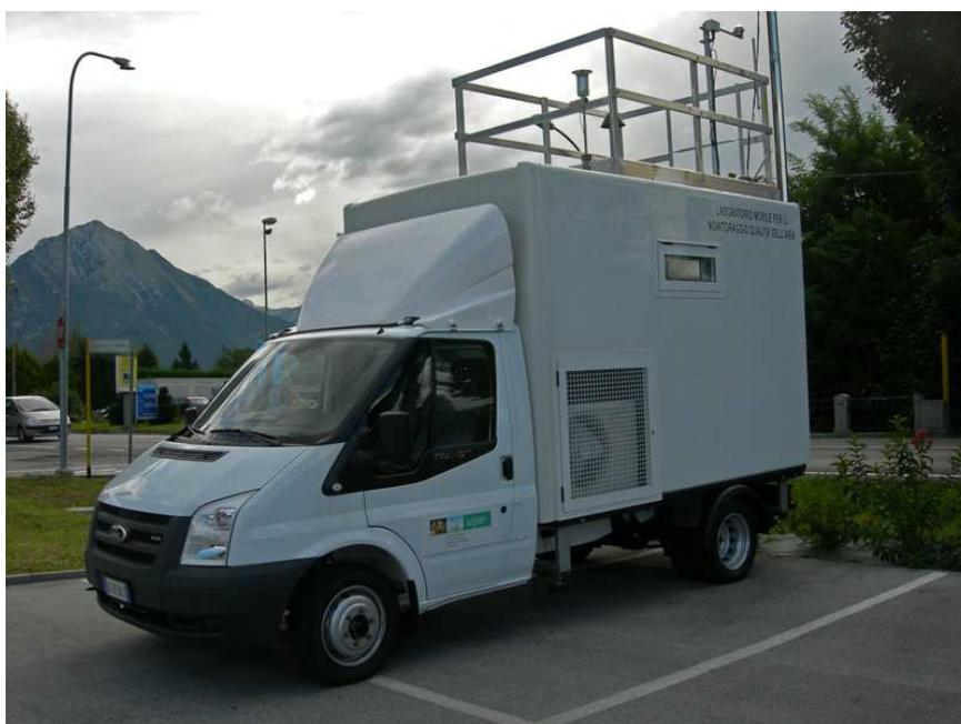
*Figura 96 - Stazione rilocabile posizionata in un cantiere per il monitoraggio della qualità dell'aria durante la realizzazione di un'infrastruttura*
