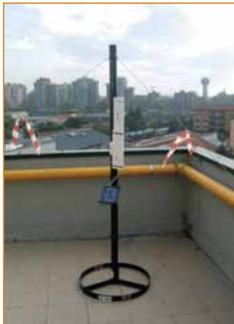
Fig. 15 Stazione di misura rilocabile EIT MCE410 - LARGA BANDA
