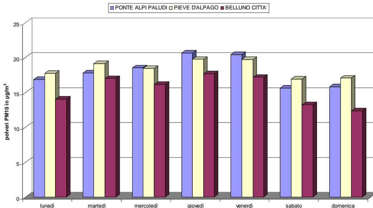
Il grafico della settimana tipo del parametro polveri per le stazioni di Belluno, Pieve d'Alpago e Ponte nelle Alpi loc. Paludi evidenzia una più elevata concentrazione di polveri PM10 a metà settimana, quando i valori del sito d'indagine superano, seppur di poco, quelli delle stazioni di confronto.
