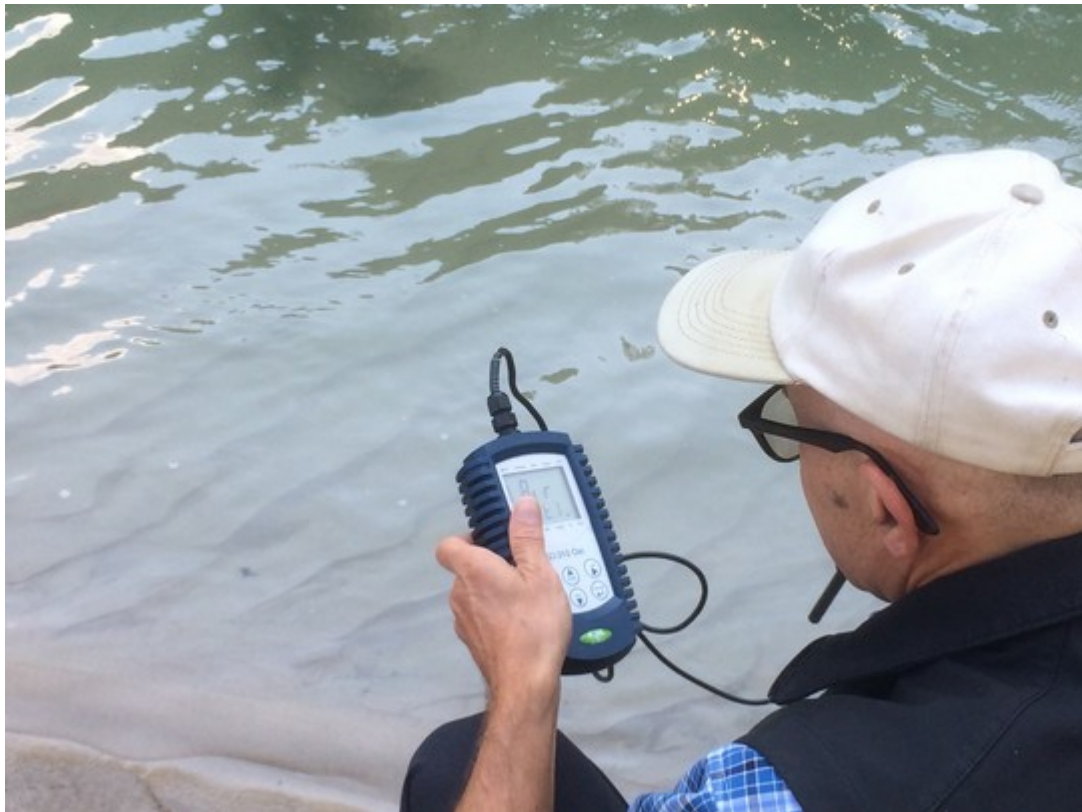
Misurazione dell'ossigeno disciolto mediante sonda digitale
