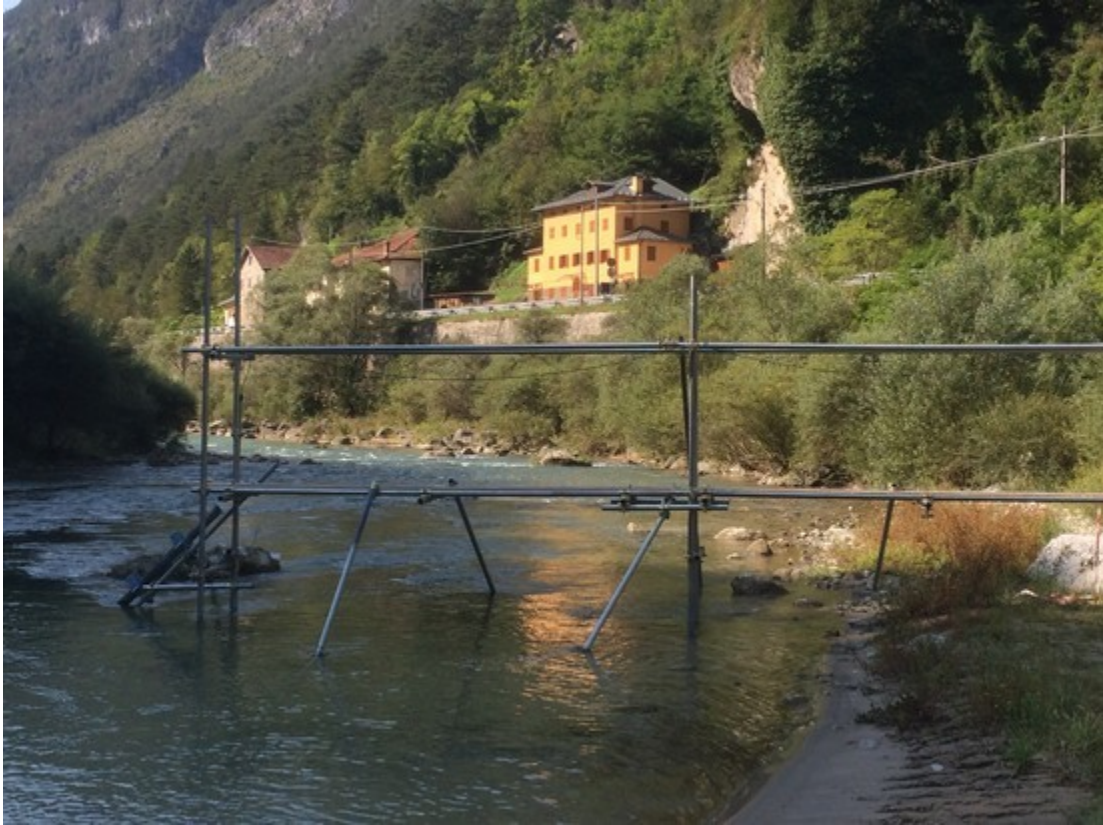
Punto di campionamento e torbidimetri sul Piave a Perarolo.
