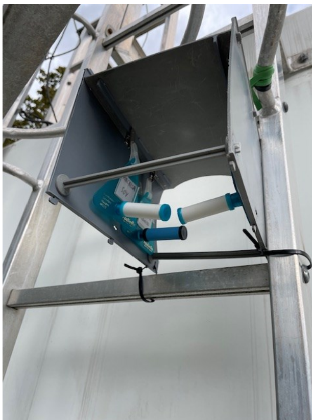
Figura 2: Campionatori passivi presso la stazione di PD-Arcella
