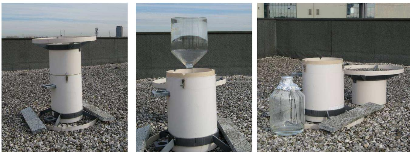
Figura 5. Deposimetro di tipo bulk, installato e pronto per il campionamento (foto in alto a sinistra), e smontato nei suoi vari componenti.
