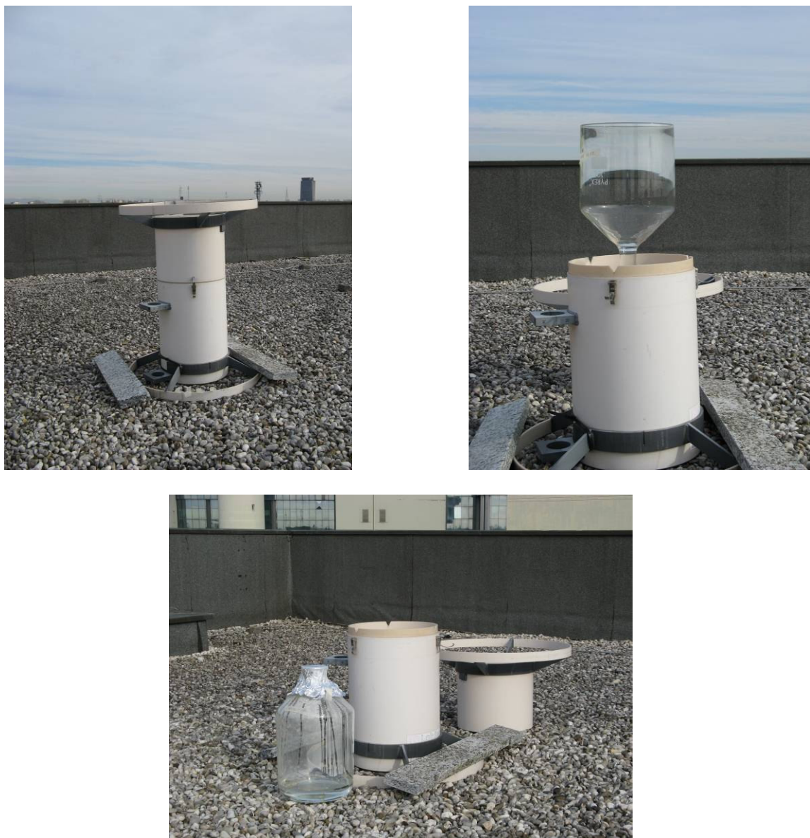
Figura 4. Deposimetro di tipo bulk, installato e pronto per il campionamento (foto in alto a sinistra), e smontato nei suoi vari componenti.
