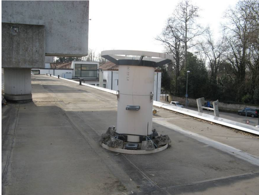
Figura 1. Deposimetro posizionato sul tetto della palestra comunale di Noventa Padovana (SITO 1).
