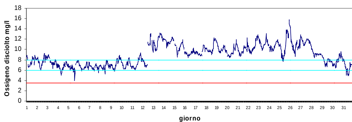
Stazione Scardovari interno Settembre 2015 - Ossigeno disciolto mg/l
