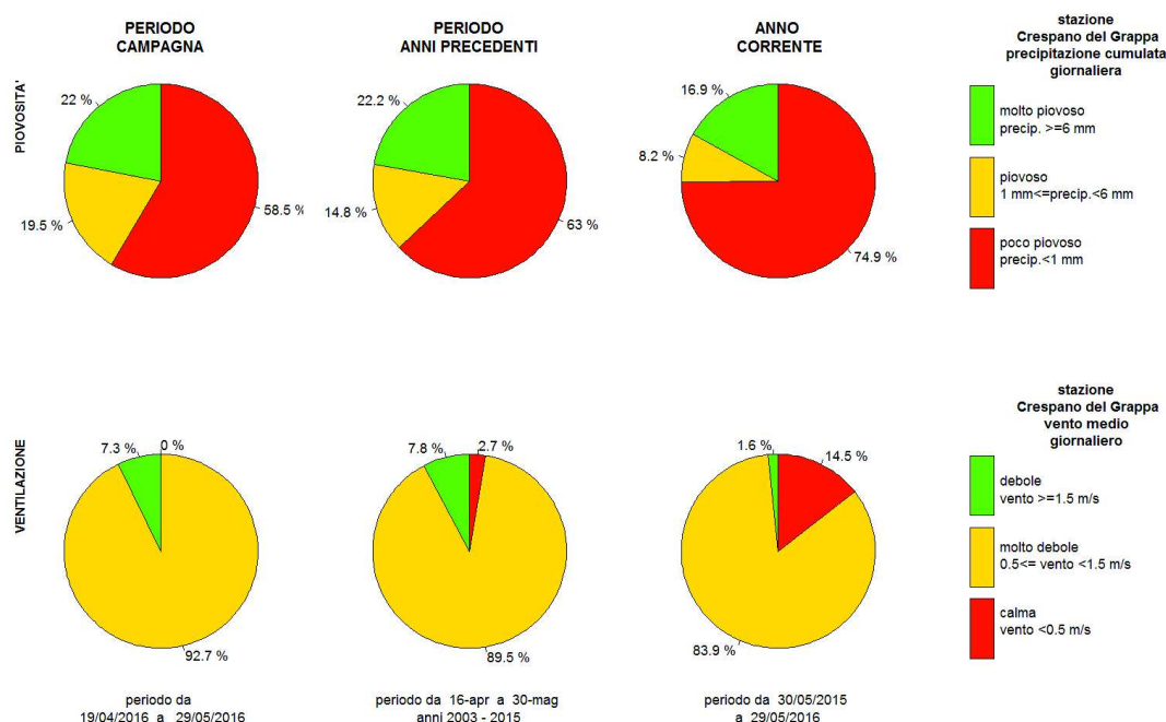
Figura 7. diagrammi circolari con frequenza dei casi di vento e pioggia nelle diverse classi: rosso (scarsa dispersione), giallo (debole dispersione), verde (forte dispersione). Confronto tra le condizioni in atto nel periodo di svolgimento della CAMPAGNA DI MISURA, nel periodo pentadale corrispondente degli anni precedenti (PERIODO ANNI PRECEDENTI) e durante l'intero anno in corso (ANNO CORRENTE).
