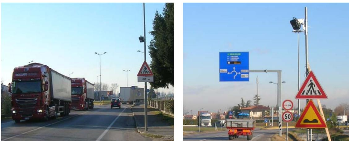
Figura 12 Installazione dei radar a microonde per il rilievo dei flussi di traffico nei due sensi di marcia di Via Camaldolesi, zona Colfrancui, nel tratto della SP n. 49 compreso tra le rotatorie di Via Masotti a Nord-Est e di Viale San Pio X a Sud-Ovest.
