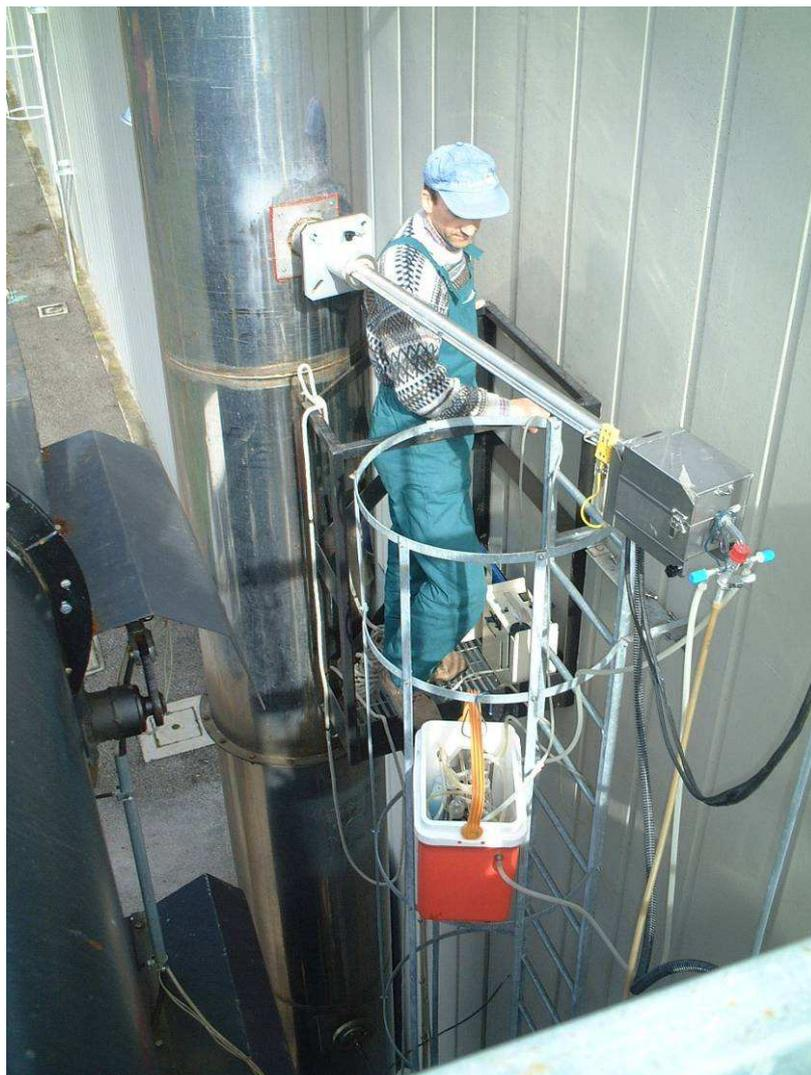
FOTO 12 – Campionamento multiparametro in condizioni di accessibilità ottimale
