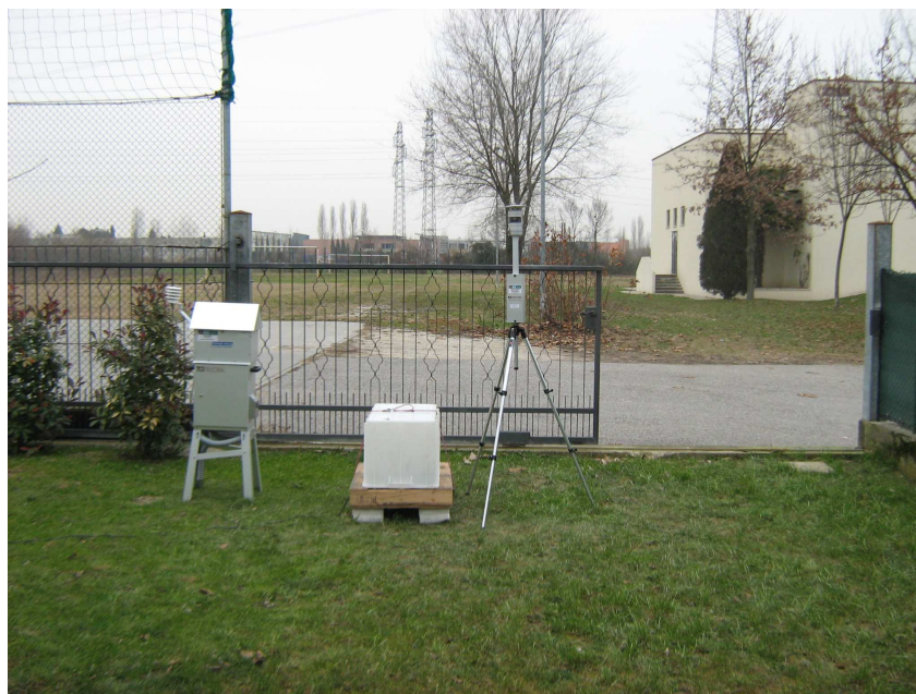
Figura 2 – Posizione 2. Strumentazione per il campionamento di PM 10 e diossine.
