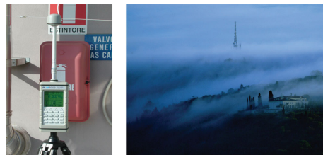
Figura 5: strumento portatile per la misura in banda larga del campo elettromagnetico
