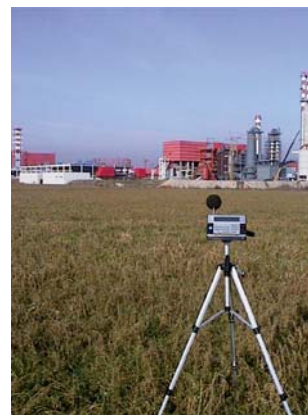
Foto 1: Strumento per la misurazione del rumore prodotto da un insediamento produttivo
