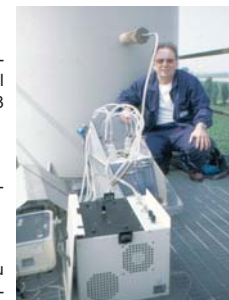
Foto 4: Controllo delle emissioni presso impianto produttivo
