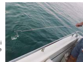
Foto 5: campionamento manuale di acqua superficiale
