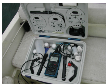
Foto 3: Strumento per la misura elettrometrica dell'ossigeno disciolto, del pH, della conducibilità e della temperatura dell'acqua.
