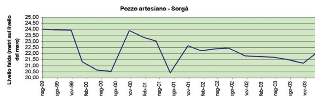
Figura 36: Andamento nel tempo delle misure di altezza di falda misurate presso il pozzo artesiano di Sorgà. (Fonte: ARPAV – Dipartimento Provinciale di Verona)
