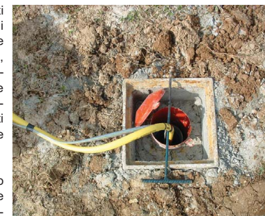
Foto 18: Piezometro utilizzato per il prelievo di campioni di acqua sotterranea
