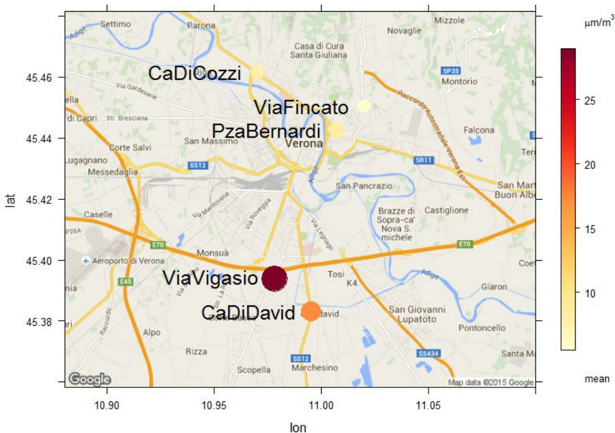
Figura 5. Differenza tra la concentrazione media giornaliera di NO 2 misurata nelle campagne con il mezzo mobile e quella misurata a Borgo Milano.
