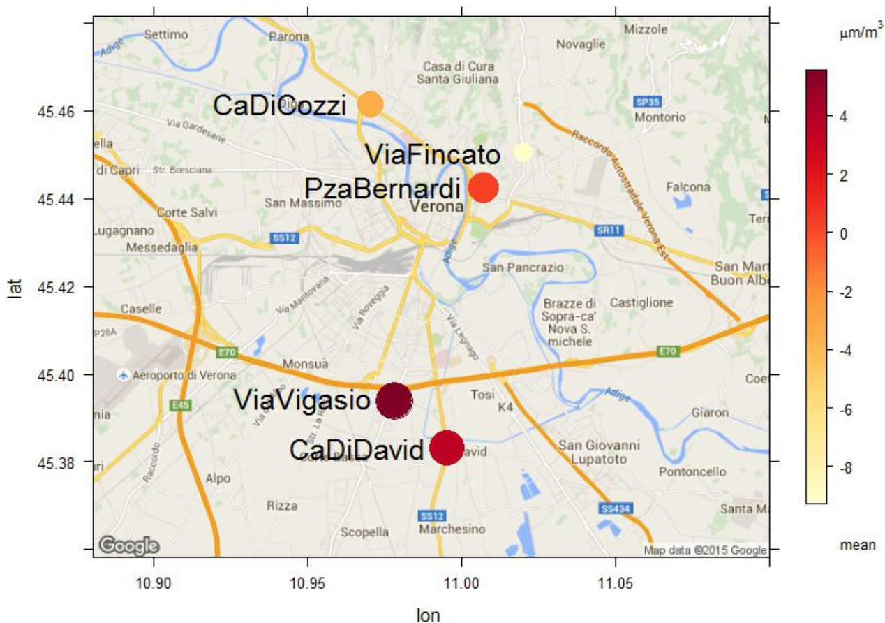
Figura 10. Della differenza tra la concentrazione media giornaliera di PM 10 misurata nelle campagne con il mezzo mobile e quella misurata a Borgo Milano.
