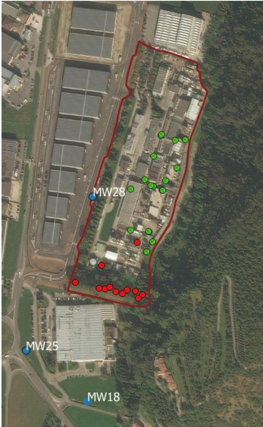
fig. 1: Piezometri realizzati presso lo stabilimento MITENI e utilizzati come barriera o punti di conformità
