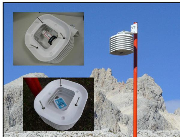
Figura 61: strumentazione utilizzata. Nei riquadri i due tipi di registratori di temperatura impiegati nel monitoraggio, inseriti nello schermo anti-radiante.
