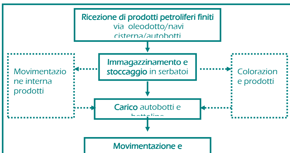
Figura 134: schema del processo – Petroven
