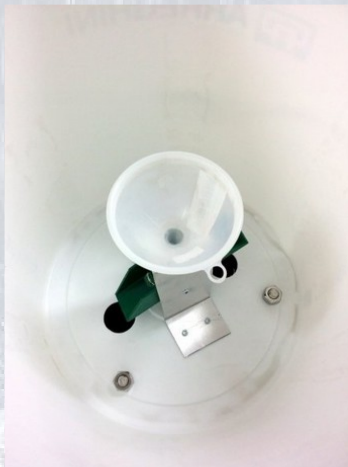
Interno del pluviometro (senza elettronica)
