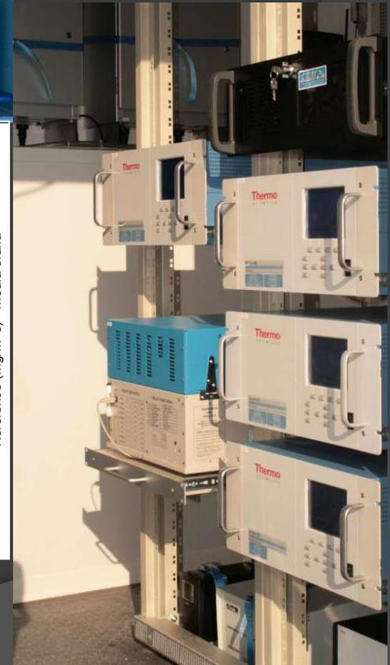
La calibrazione segue una procedura di test che confronta il SENS-IT con un metodo di riferimento (analizzatori gas)
