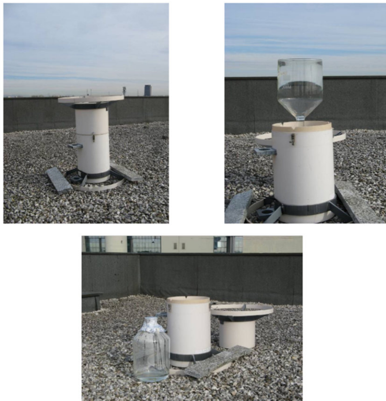
Figura 13: deposimetro di tipo bulk, installato e pronto per il campionamento (foto in alto a sinistra) e smontato nei suoi vari componenti
