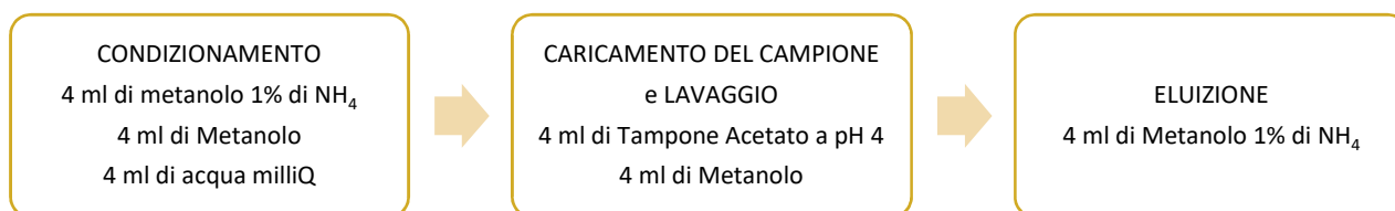
Figura 9: schema di utilizzo cartucce spe
