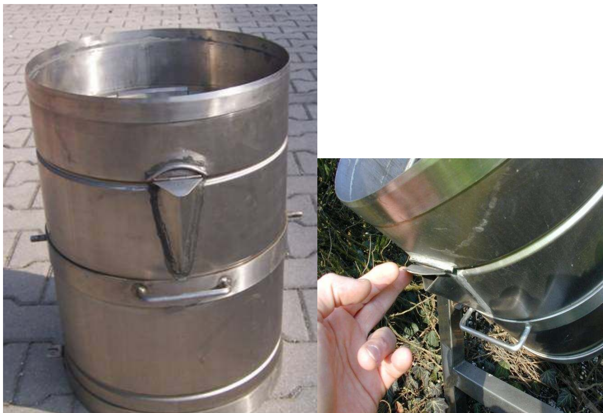
Fig.6 – Pluviometro totalizzatore C. 10: vista di fronte e particolare del beccuccio apribile per lo svuotamento dell'acqua nel cilindro graduato
