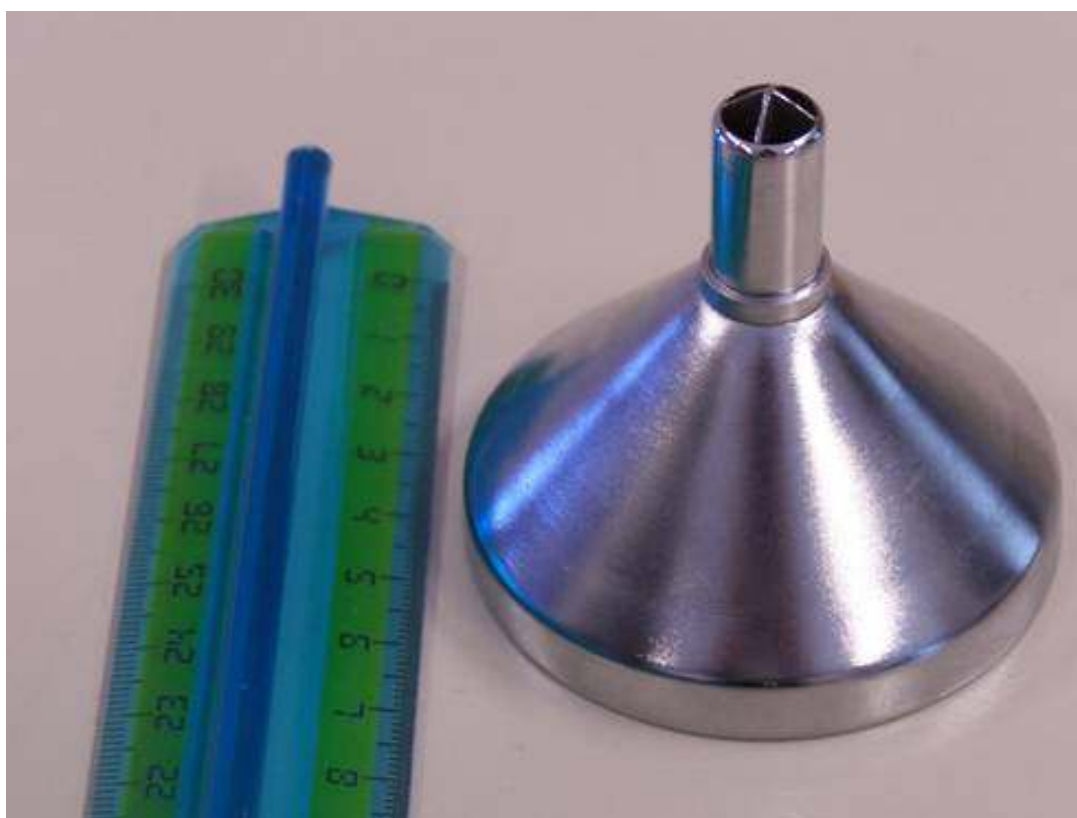
Fig.14 - Pluviografo Registratore tipo M. 20; particolare dell'imbuto con rompigoccia che convoglia l'acqua sul sistema di vaschette basculanti
