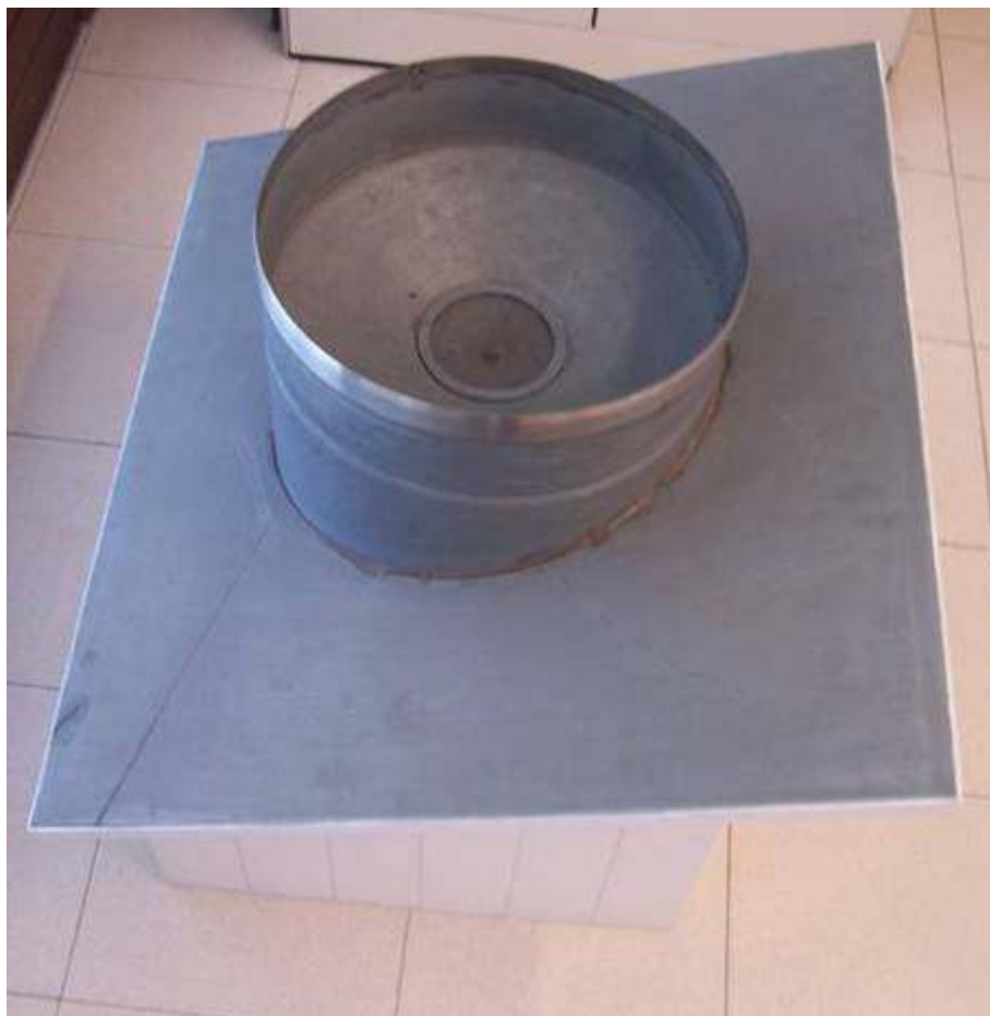
Fig.15 - Imbuto di cattura per pluviografo registratore tipo M. 20 collocato sul tetto della capannina lignea. Superficie captante 1000\text{ cm}^2 diametro 35,7 cm
