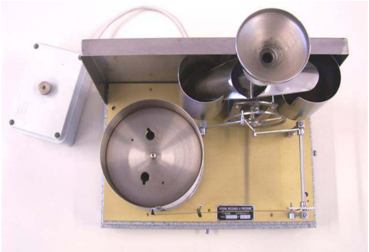
Fig.9- Pluviografo visto dall'alto: è ben evidente il sistema di trasmissione delle misure di pioggia dal sistema basculante al pennino scrivente; il cilindro con pluviogramma, in questo caso, viene fatto ruotare da un motorino elettrico alimentato dalla scatola a sinistra anziché dal meccanismo a orologeria caricabile a molla
