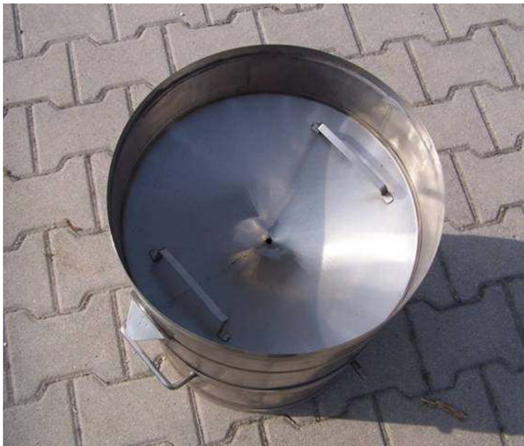
Fig.5 – Pluviometro totalizzatore C. 10 con coperchio: vista dall'alto
