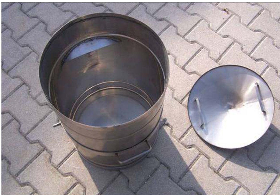
Fig.4 – Pluviometro totalizzatore C. 10 con coperchio rimosso, in configurazione per la misura della precipitazione nevosa
