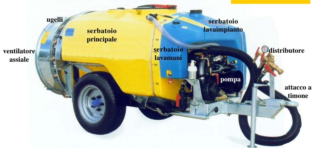
irroratrice trainata per colture arboree (atomizzatore)
