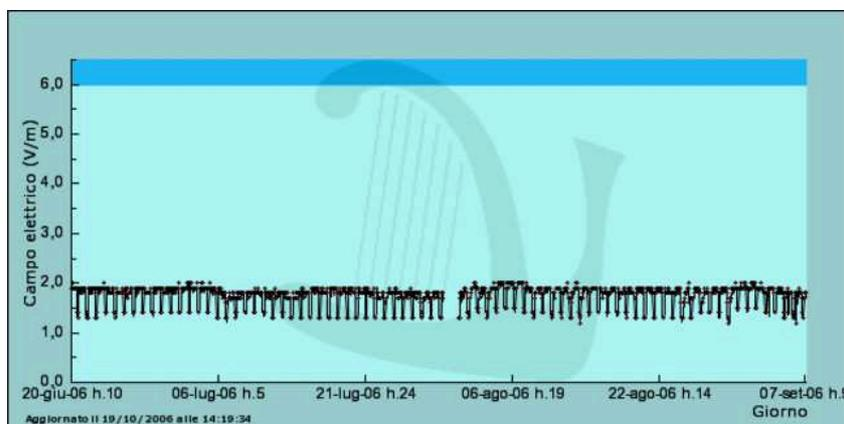
Il grafico mostra, in ascissa, il periodo di rilevamento e, in ordinata, la media ed il massimo orari del campo elettrico in V/m; sull'asse delle ordinate è evidenziato anche il valore di attenzione/obiettivo di qualità di 6 V/m previsto dalla normativa vigente.
