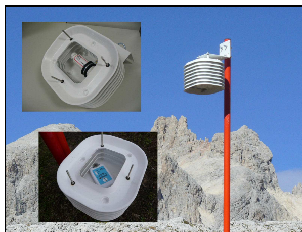
Figura 61: strumentazione utilizzata. Nei riquadri i due tipi di registratore di temperatura impiegati nel monitoraggio, inseriti nello schermo anti-radiante.
