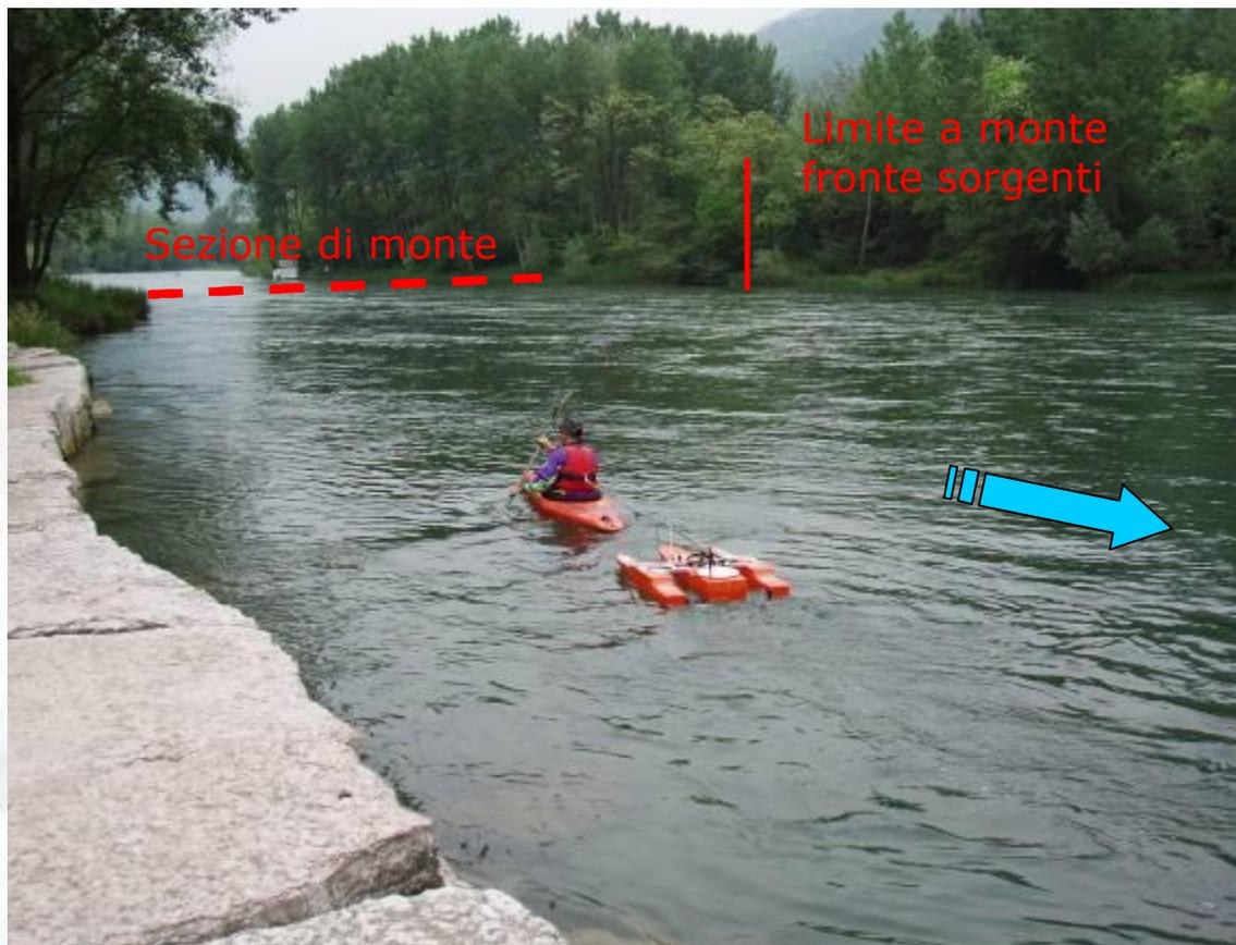
Poiché il Fiume Brenta è a sua volta soggetto a continue variazioni di portata per via delle numerose utilizzazioni idroelettriche operanti nel bacino a monte, risulta fondamentale poter eseguire le misure il più rapidamente possibile e in situazioni idrometriche stabili, per es. di domenica (nel periodo invernale)
