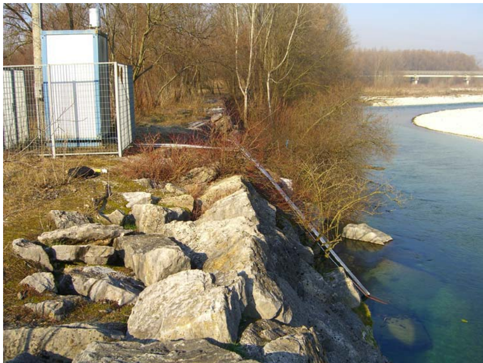
Figura 17. Posizionamento del trasduttore di pressione collocato in corrispondenza della sezione di misura di Fontaniva ed utilizzato per l'acquisizione in continuo del livello idrometrico con cadenza temporale pari a 15 minuti. Lo strumento è stato installato temporaneamente per l'acquisizione idrometrica dal 18 al 20 febbraio 2008.
