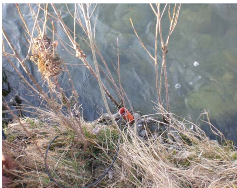
Figura 14. Rilevazione automatica delle altezze idrometriche presso la sezione di Marchesane mediante trasduttore a pressione.
